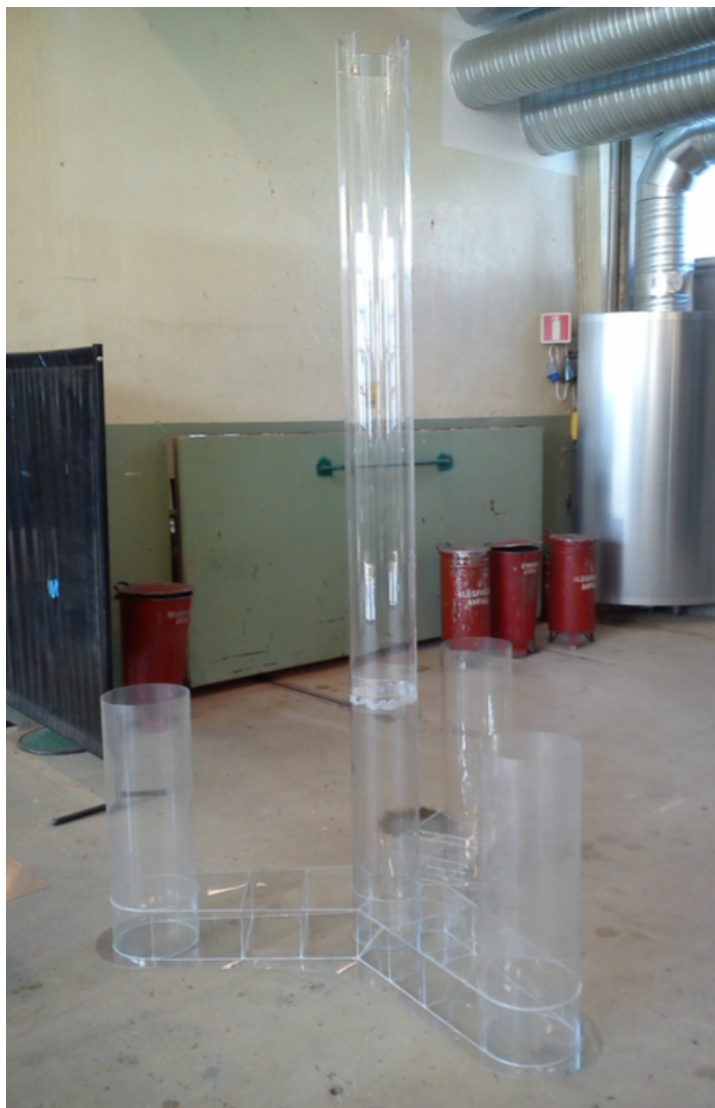
Figur 3.1: Skalamodell av Dr. Techn. Olav Olsen Star Wind Floater (Kelberlau, 2013).
