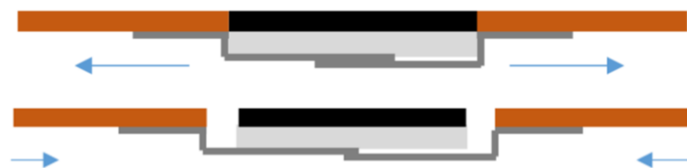
Figur 8.3.1: Skinnbasert sammensetting av bordplate. Av Egen illustrasjon.
