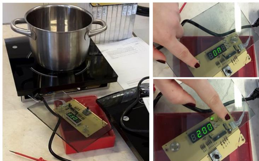
Figur 8.6.2: Test av touch-knapper, prototypeprosjekt. Egne foto.
