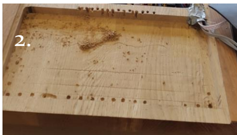
Figur 8.5.2: 1. Nedfresinger og utsaginger i bordplate. 2. Nedfresing av styrerom. Egne foto.
