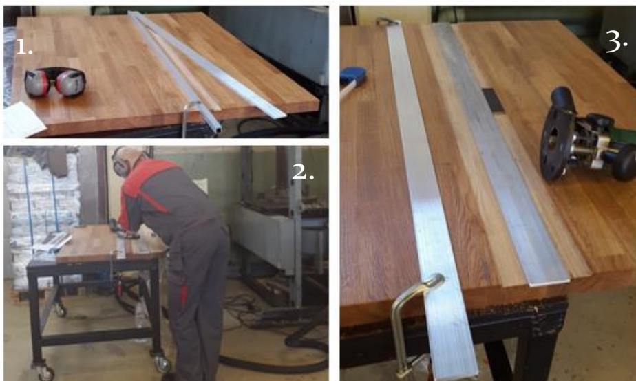
Figur 8.5.1: 1. Første spor nedfrest i bordplate. 2. Gunnar på verkstedet i full gang med fresing. 3. Flere spor frest, halveis ferdig. Fresing gjort på IMTs verksted ved NMBU. Egne foto.
