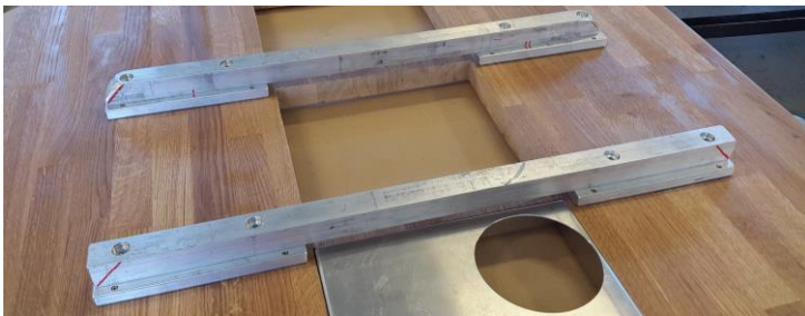
Figur 8.5.3: Montering av avstivere på bordplate. Eget foto.
