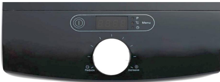
Figur 6.3.4: Wilfa Indux ICP-2000, brukergrensesnitt. Innehar svinghjul samt på/av-knapp og meny-tast. Led-lys illustrerer valgt funksjon. Revidert fra[28]
