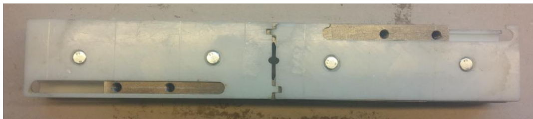
Figur 76 – Innerste posisjon for skrapepinner. Representeres ved gjenget hull i tannstangen.
