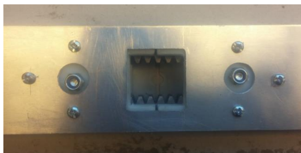
Figur 75 – Intern mekanikk klar for påmontering av steppermotor
