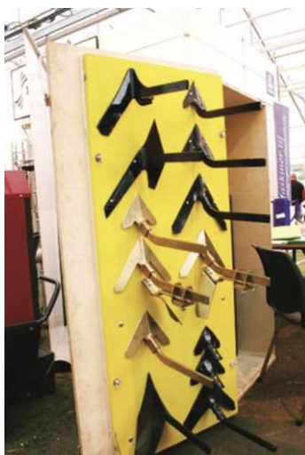
Figur 12 – Gåsefotskjær for påmontering ugressverktøy [6]
