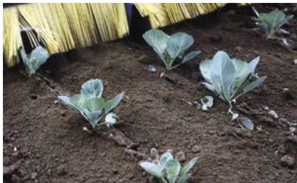
Figur 10 – Roterende børste i arbeid mellom planteradene [6]
