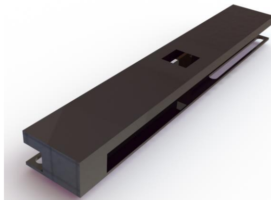
Figur 42 – Komponent for sammenstilling av interne komponenter tilknyttet bevegelige skrapepinner
