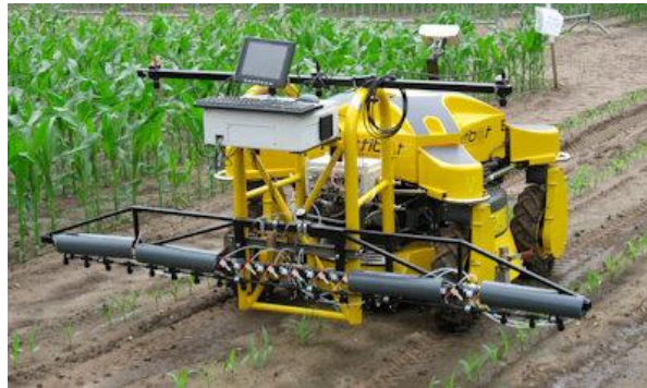
Figur 5 – Hortibot, autonom landbruksrobot med verktøy for selektiv sprøyting [9]
