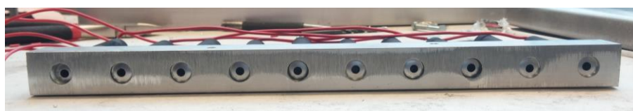
Figur 79 – Underside av lasersensor med laserpekere og sensormoduler
