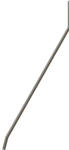
Figur 44 – Skrapepinne tilpasset sideveis bevegelse
