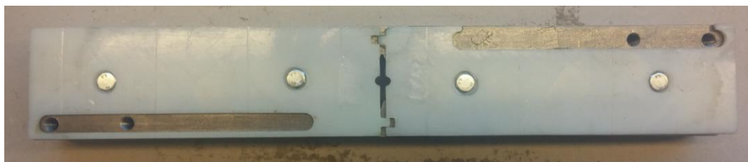
Figur 77 – Ytterste posisjon for skrapepinner
