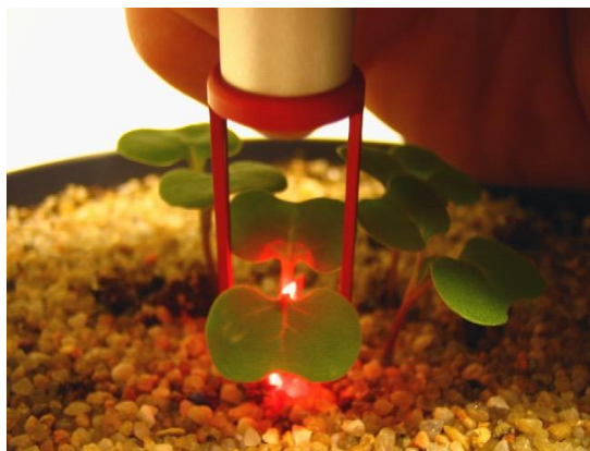
Figur 9 – Bestråling av ugressets stamme med et håndholdt laserredskap [25]
