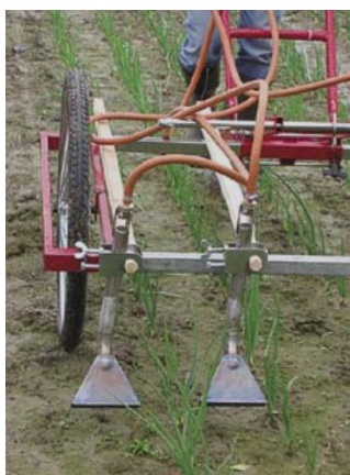
Figur 13 – Blåselamper påmontert en ramme for flamming av ugress mellom planterader [6]
