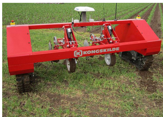
Figur 4 – Autonom robot med verktøy for mekanisk ugressbekjempelse [8]
