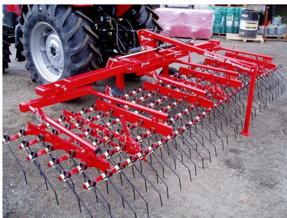
Figur 16 – Skrapepinneverktøy med fast innbyrdes avstand påmontert en tradisjonell traktor [6]
