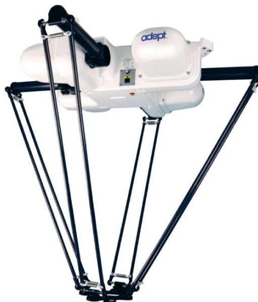
Figur 20 – Parallellrobot bestående av tre eller flere armer koblet til stasjonært montert elektromekanikk [31]
