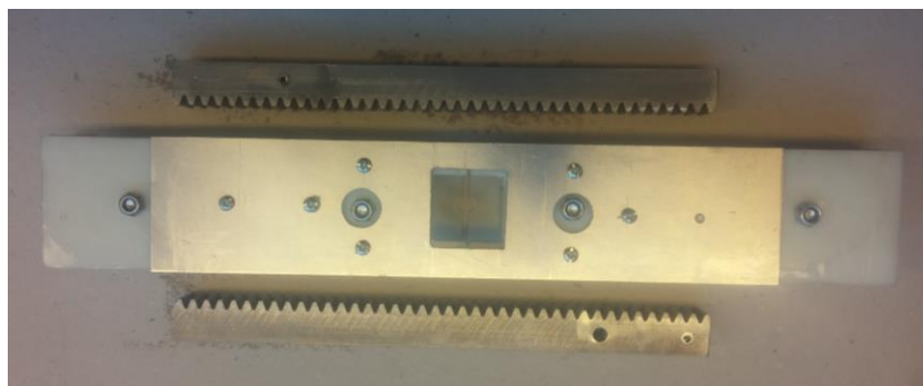
Figur 74 – Tannstenger, 3D-printede rammer og sammenstillingsplater av aluminium i redskap for bevegelige skrapepinner
