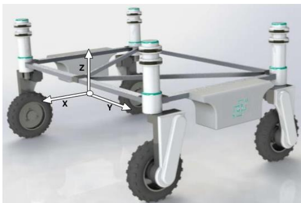
Figur 7 – Autonom landbruksrobot utviklet ved NMBU. Skal benyttes som plattform for autonomt verktøy for ugressbekjempelse. X - retning er robotens kjøreretning [21]
