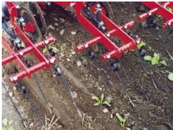
Figur 11 – Skrapepinner med fjæring som arbeider mellom planteradene [6]
