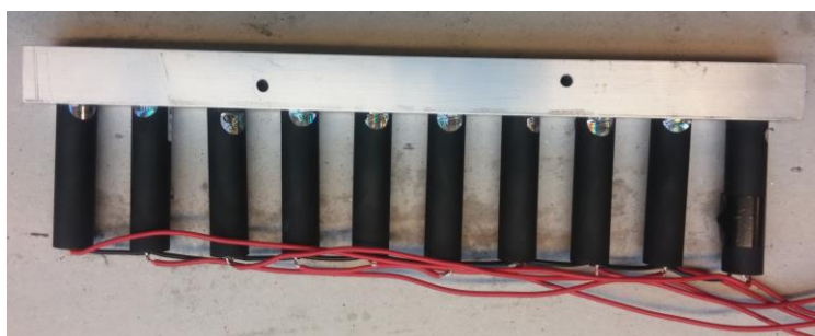
Figur 78 – Sammenstilling av lasere i ramme av aluminium
