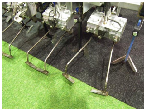
Figur 3 – Robovator består av moduler med bevegelige skrapepinner samt gåsefotskjær som kontinuerlig arbeider under jorden mellom planteradene [6]
