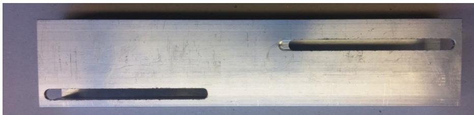
Figur 73 – Bearbeidet aluminiumprofil for installering av mekanikk
