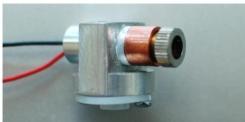
Figur 50: Innkjøpt Nichia NDB7875 lasermodul påmontert brakett av aluminium
