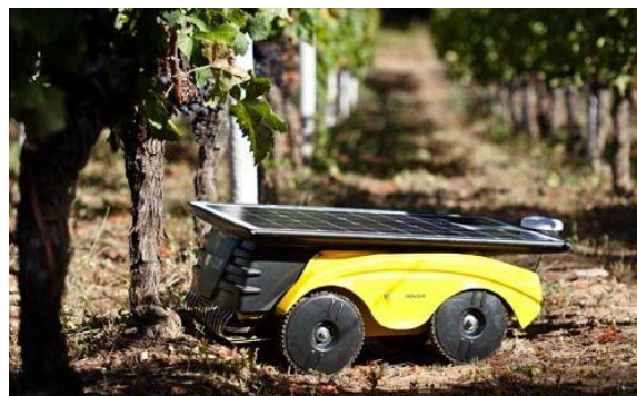
Figur 2 – Vitirover, autonom robot for kutting av gress i vinranker [7]
