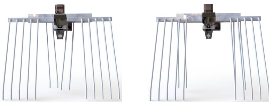
Figur 35 – Skrapepinnenes innerste (t.v.) og ytterste (t.h.) posisjon
