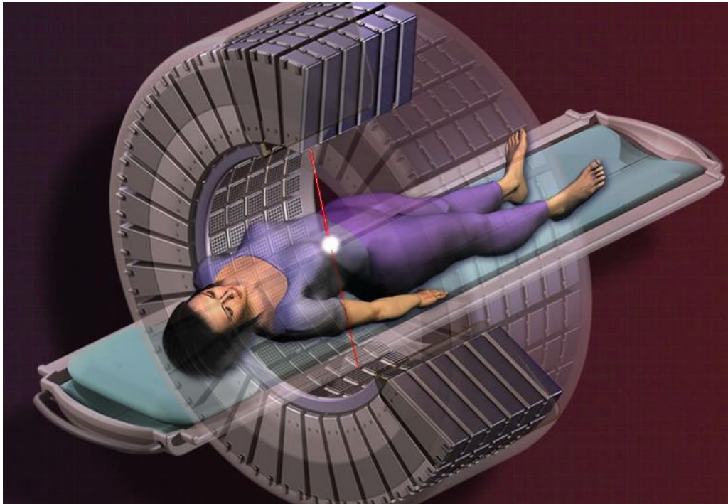
Figur 2: En PET-skanner består som regel av flere ringer av detektorelementer, som omringer pasienten. Detektorelementene registrerer treffpunkter til fotonpar i koinsidens, for å kunne bestemme mengden og lokasjonen til radionukliden i objektet. Bildet er benyttet med tillatelse av illustratør Griff Wason, [20].
