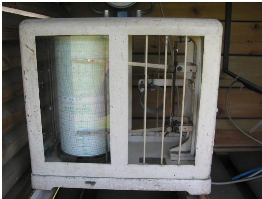
Figur 4: Mekanisk hygrottermograf. Foto: Signe Kroken.
