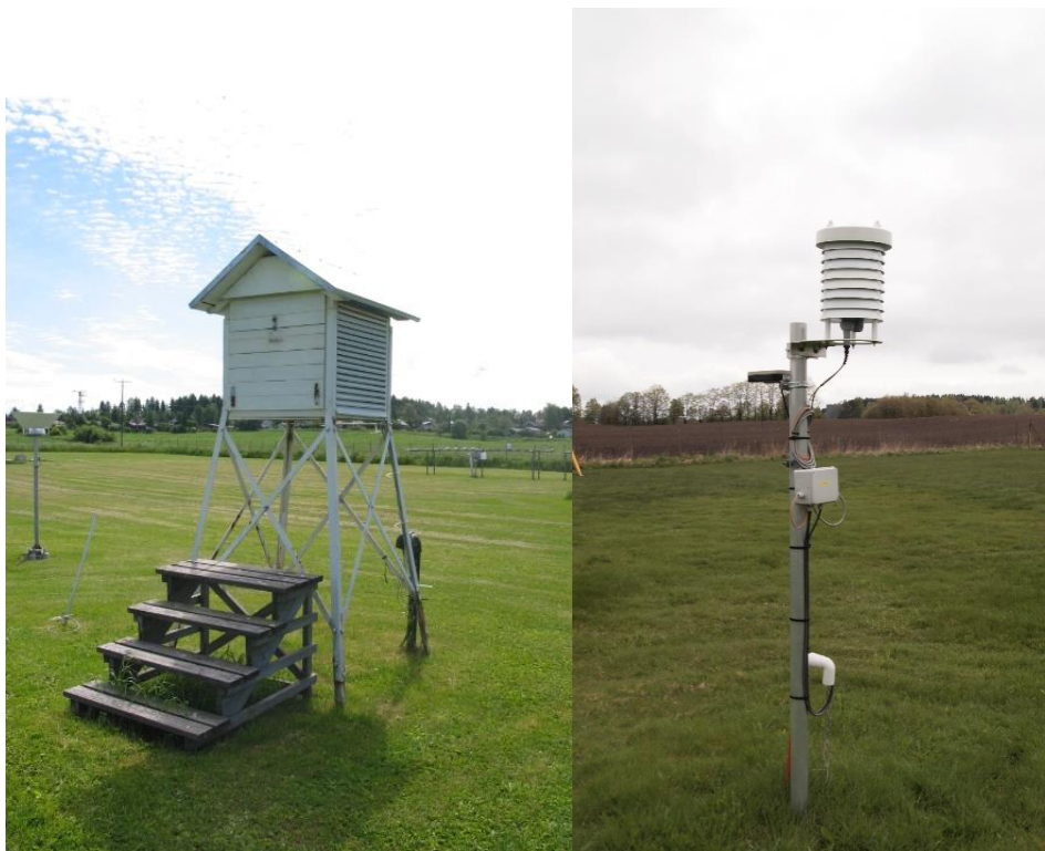
Figur 9: Strålingsskjermene på Søråsfeltet. Trehytten til venstre er av typen MI-46, mens plastskjermen til høyre er av typen MI-2001b. Foto: Signe Kroken
