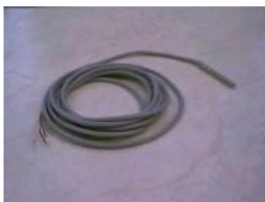
Figur 1: PT-100 sensor. Foto: Signe Kroken
