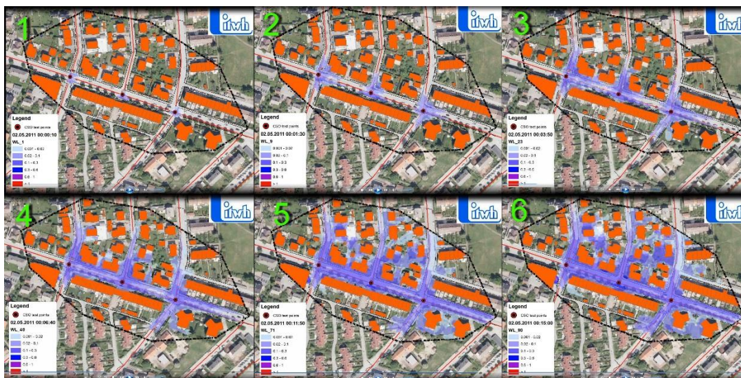
Figur 56. Eksempel på resultat fra en mer avansert modell i 3D. Fra bilde 1 - 6 kan man se hvordan vann som kommer opp fra gatekummer sprer seg på overflaten med tiden. Figuren er sammensatt av skjermdumper fra en illustrasjonsfilm utviklet av itwh
