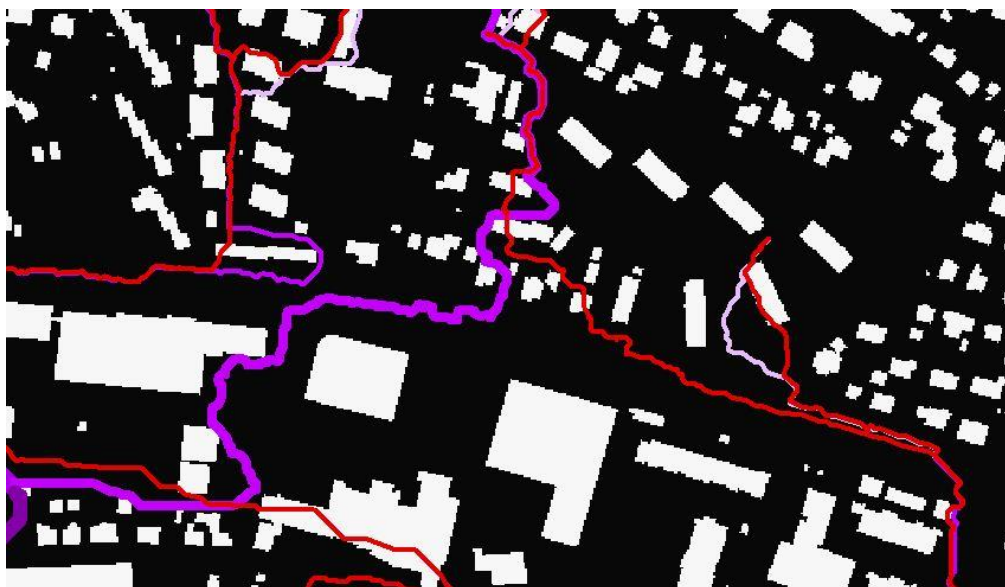
Figur 55. Eksempel på hvor ulike resultater man kan få ved å gjennomføre analyser av en modell med bygg (drenslinjer i lilla) og en modell uten bygg (drenslinjer i rødt)
