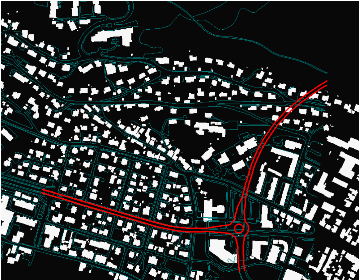
Figur 36. Viser i rødt FKB-data med attributtbetegnelsen «Medium = 'U'» som ikke ble tatt med i terrengmodellen
