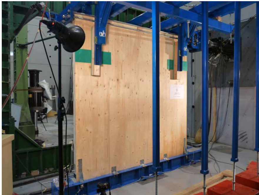
Fig. 2. CLT test setup
