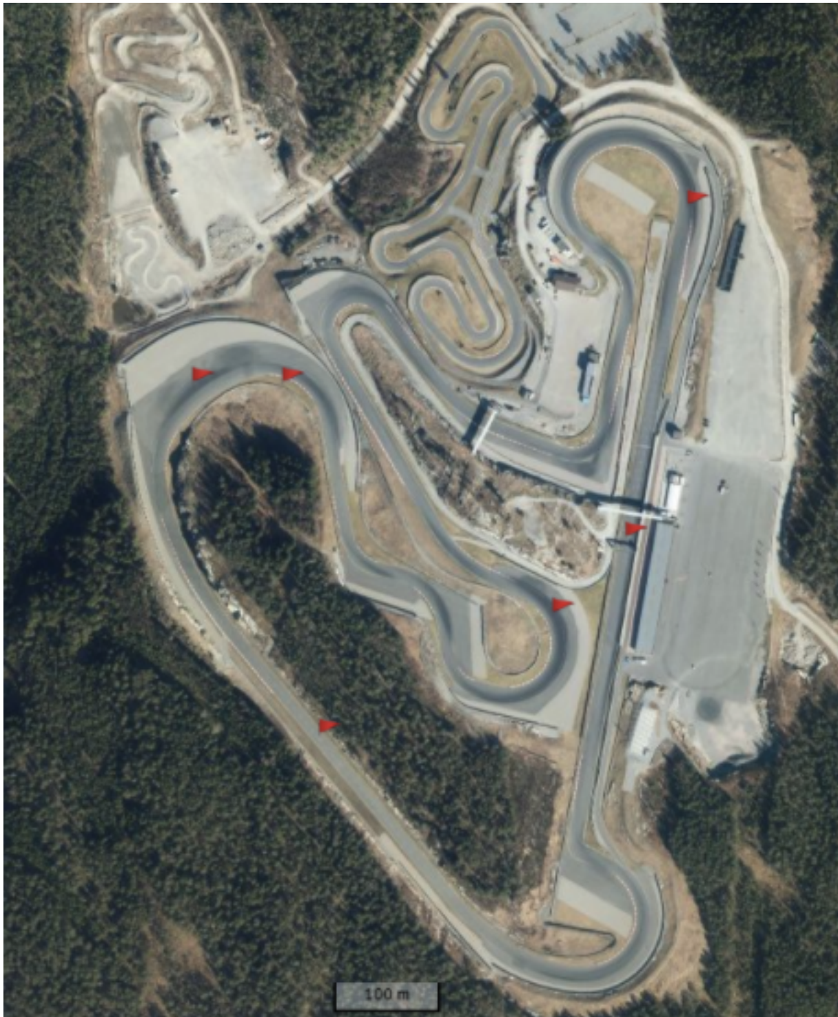
Figur A.1: Planlagte prøvetakingspunkter for sedimentprøver ved Rudskogen motorsenter. De planlagte punktene er (med klokken): ved start/mål, midt på langstrek/rettstrek, ytter - og innersving etter rettstrek, yttersving, yttersving før mål/start. Bakgrunnskart hentet fra Kartverket (2021).
