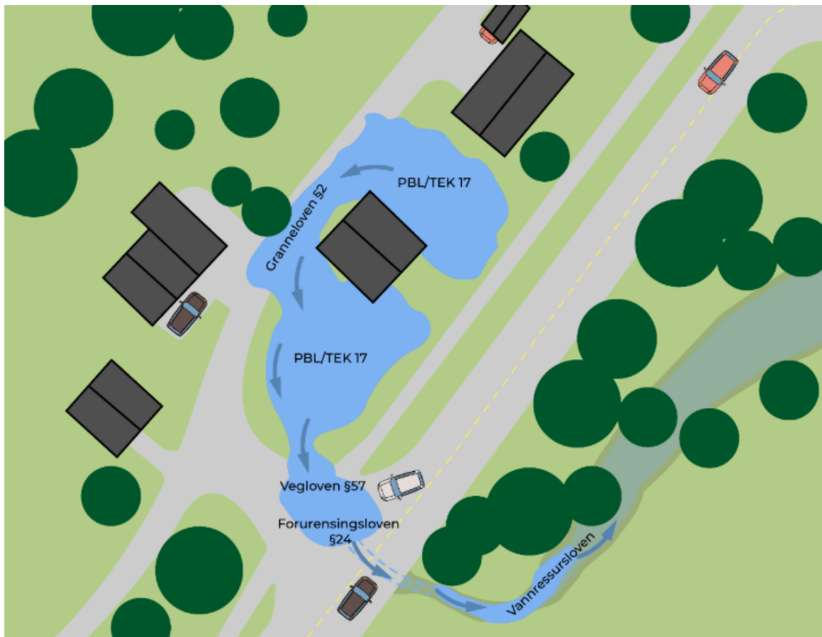
Figur 2.5: Illustrasjon av hvilke lover og forskrifter som gjelder under transport av overvann (Sivertsen mfl., 2020).
