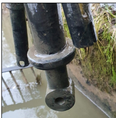
Figur 9. Sensorene ble benyttet for kontinuerlig å logge vannkjemien i bekken nedstrøms deponiet; venstre, pH-probe; midten, indirekte konduktivitets-probe (ikke-benyttet) og høyre, konduktivitets-probe. (Foto: Andreas Smebye)
