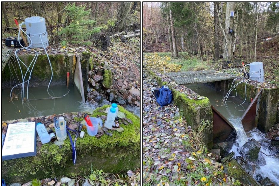
Figur 6. Prøvested nedstrøms deponiet (112). Passive prøvetakere er plassert foran V – overløp, stikkprøvene tas i V-overløpet. Isco blandprøvetager i bakgrunnen. (Foto: AH Rosenvinge)
