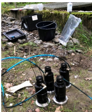
Figur 13. Til venstre: flasker med SorbiCell fra prøvepunkt nedstrøms deponiet ved opptak. Til høyre: DGT og SorbiCell etter opptak og før forsendelse til lab. (Foto: AH Rosenvinge)
