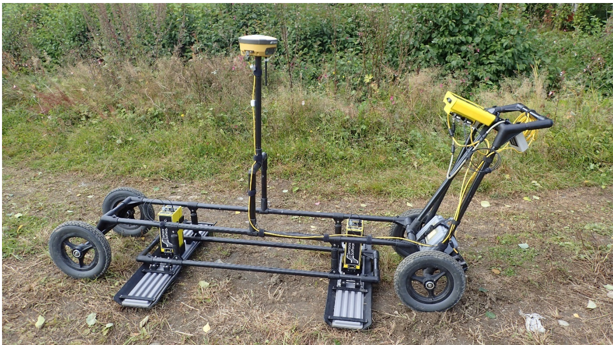
Figur 3-5 Ground Penetrating Radar ved lokasjon 4003 på Jorekstad. 100MHz antenner er festet under vognen og en GPS sender/mottaker er montert midt på vognen. Foto: Stian Bruvoll.
