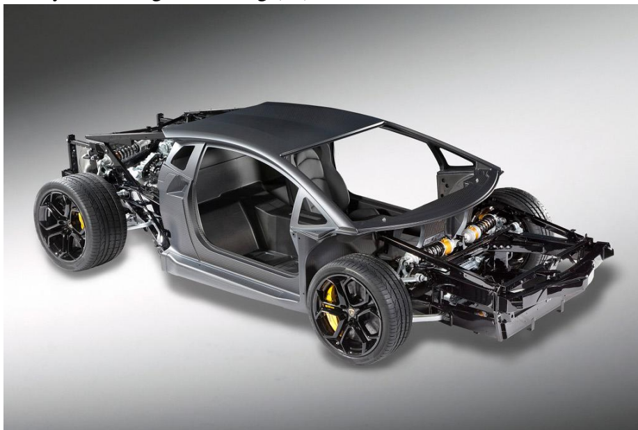
Figur 4.12: Moderne Lamborghini Aventador har monocoque-konstruksjon basert på dataoptimering (54).
