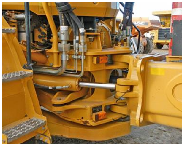
Figur 4.10: Store køyretøy, som den avbilda hjullastaren nyttar hydraulisk styring (51).
