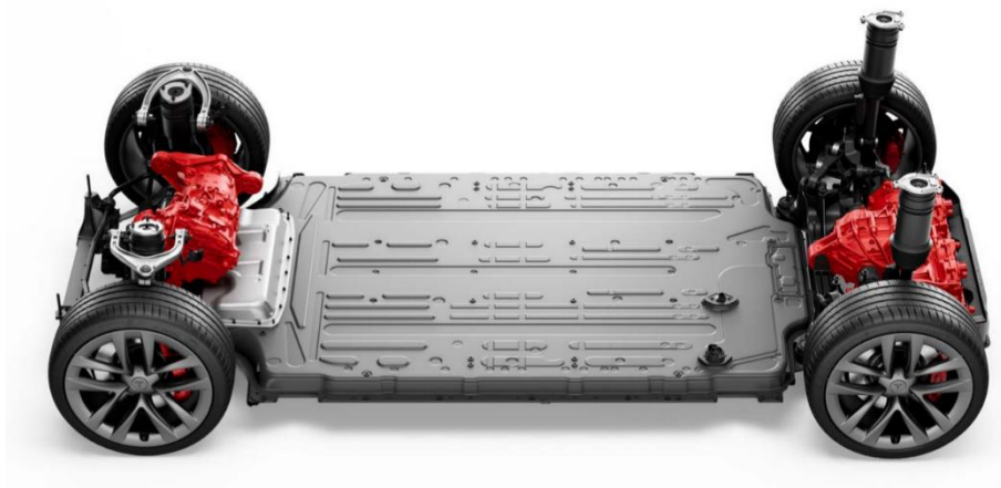
Figur 4.14: Tesla Model S nyttar ein plattform-ramme (57).
