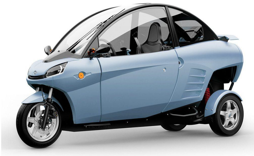
Figur 1.13: Carver, den elektriske scooteren med DVC (28).
