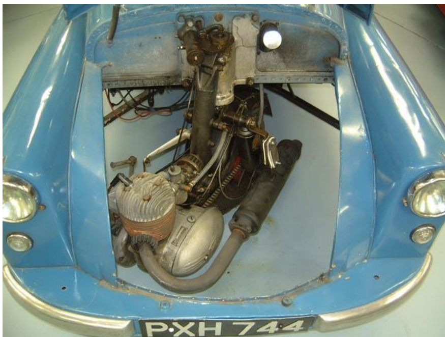
Figur 4.8: Bond Mk C nyttar ormegir og sektorstyring (20).
