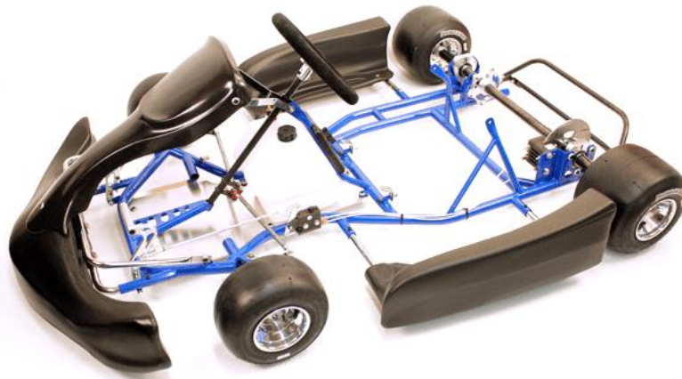
Figur 4.11: Ei go-kartramme er bygd opp av røyr (52).
