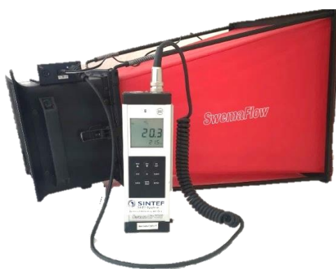
Figur 3-9: Anemometer (SwemaAir 300) tilkoblet måletrakt (SwemaFlow 125) Foto: Cathrine Hafnor
