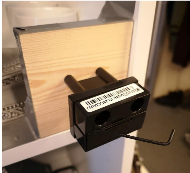
Figur 3-21: Trefuktmåler plassert i leilighet. Foto: Cathrine Hafnor
