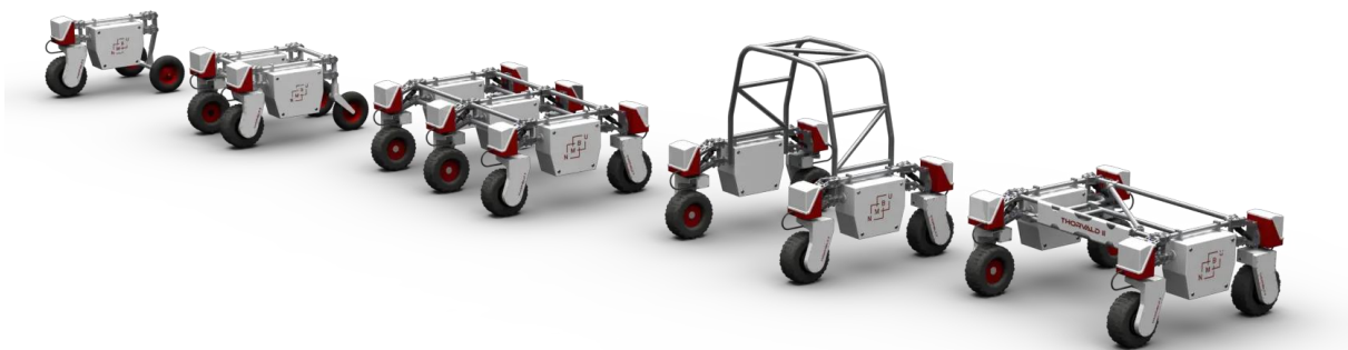
Figur 10: Saga Robotics (2021) Flere mulige konfigurasjoner av Thorvald. Tilgjengelig fra: https://sagarobotics.com/pages/thorvald-plattform . (lest: 09.02. 2021).
