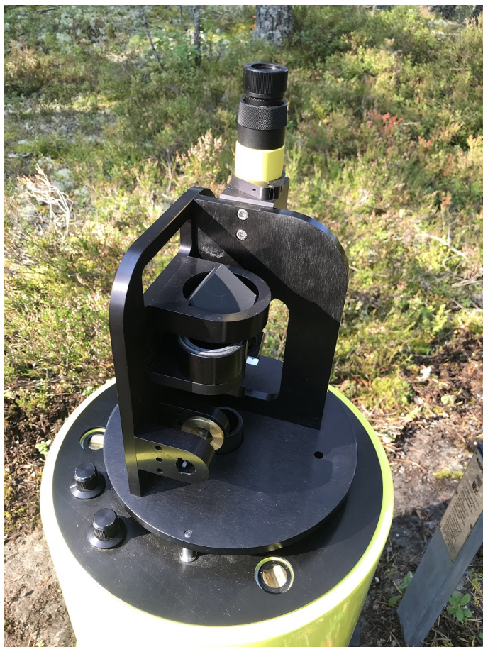
Figur 2.3: Vertikalisering av laser med beam-checker.
