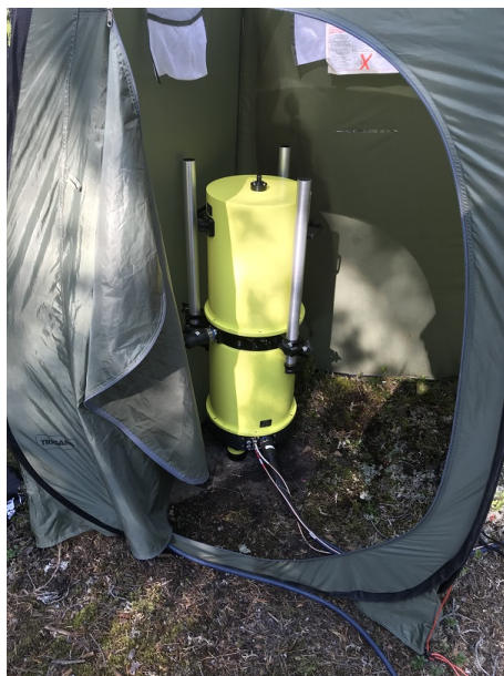
Figur 5.5: A10-42 under måling i stasjonen Jaklefoss på Ringerike. Det settes opp telt rundt instrumentet hvis det er mye vind.
