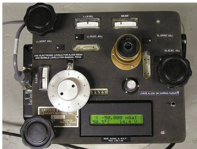
Figur 2.5: LCR G-761 relativgravimeter med digital avlesning. Foto: Kristian Breili.
