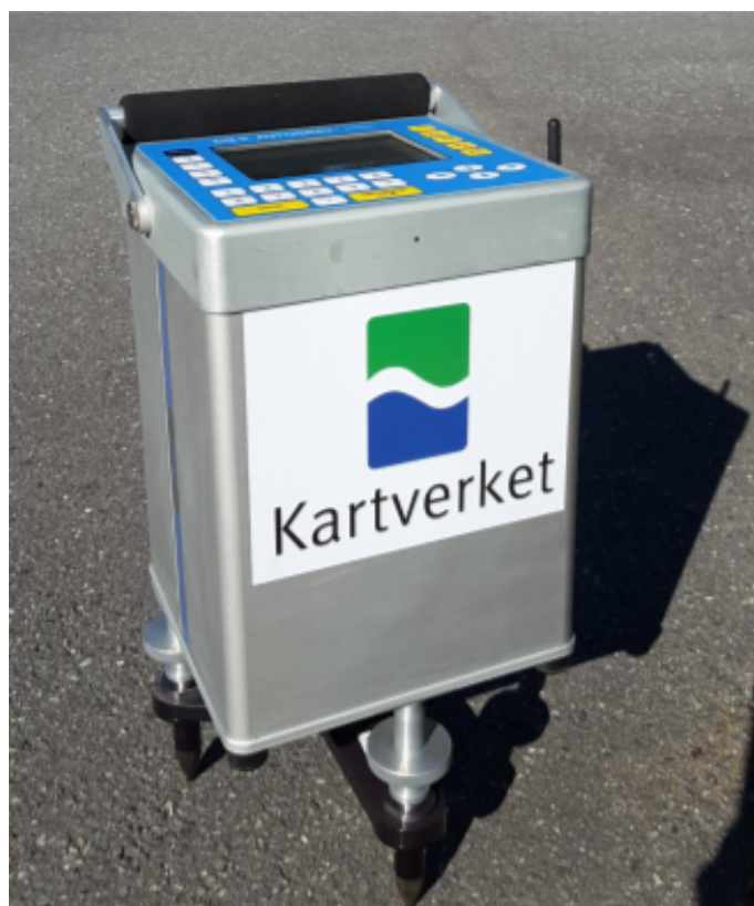
Figur 2.6: Scintrex CG5 relativgravimeter. Foto: Kristian Breili.
