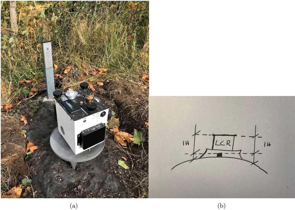
Figur 5.1: a) oppstilling på gravimeterskål i stasjonen Borgergrenda, b) instrumenthøyde med gravimeterskål.
