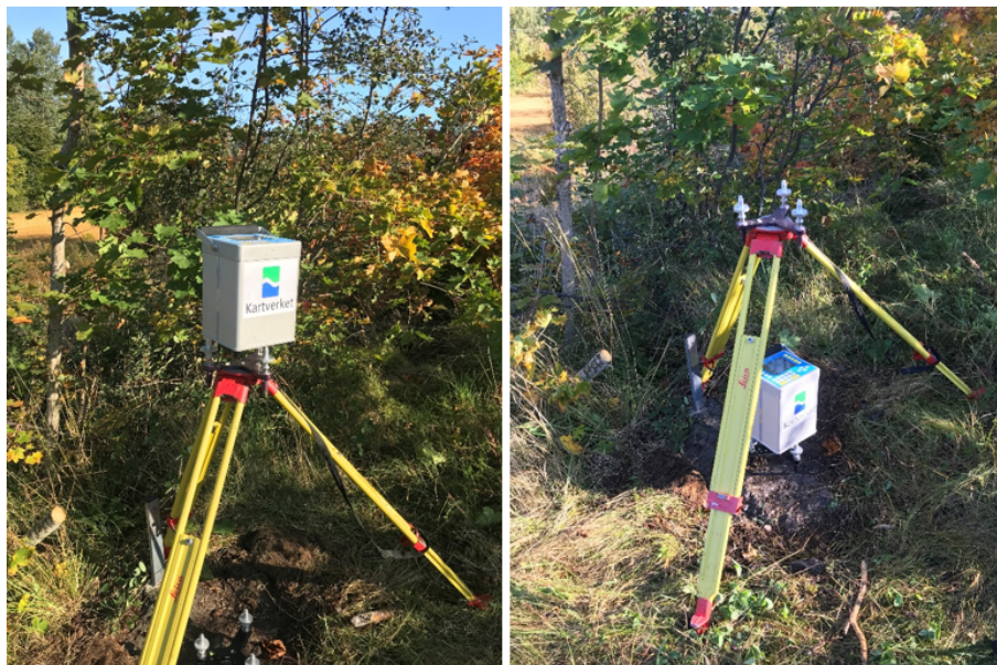
Figur 7.1: Typisk oppstilling for gradientmåling med Scintrex CG5. Her på Ringerike i punktet Borgergrenda. Til venstre er gravimeteret i øvre posisjon, og til høyre i nedre posisjon.
