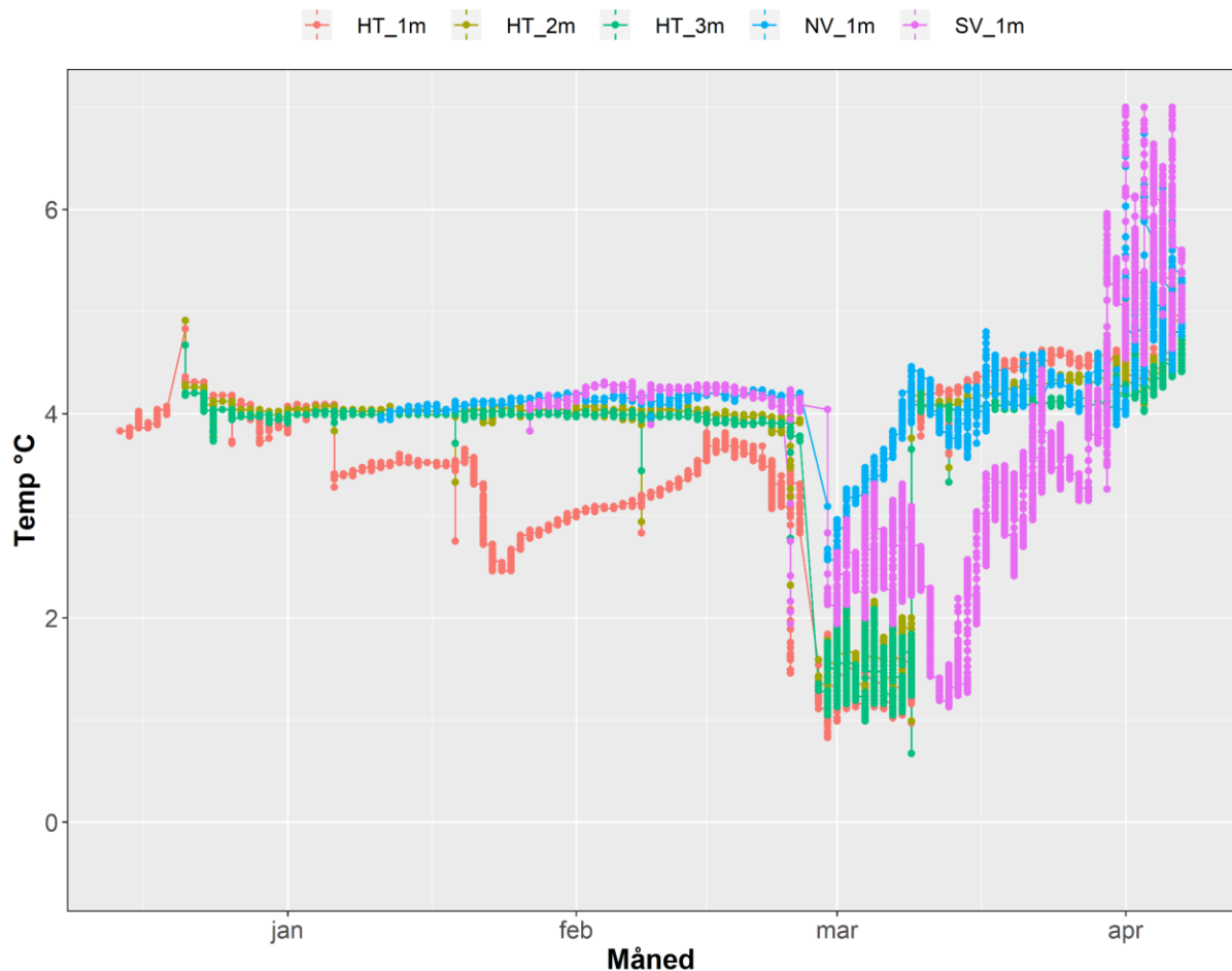
Figur 28: Vanntemperatur målinger fra loggere i perioden desember 2020, til april 2021. I Holmetjernet er det data fra loggere satt på 1,2 og 3 m dyp. For Væhletjerna er målingene tatt fra loggere på 1 m dybde. Orange linje: Vanntemperatur målinger fra logger i Holmetjernet
