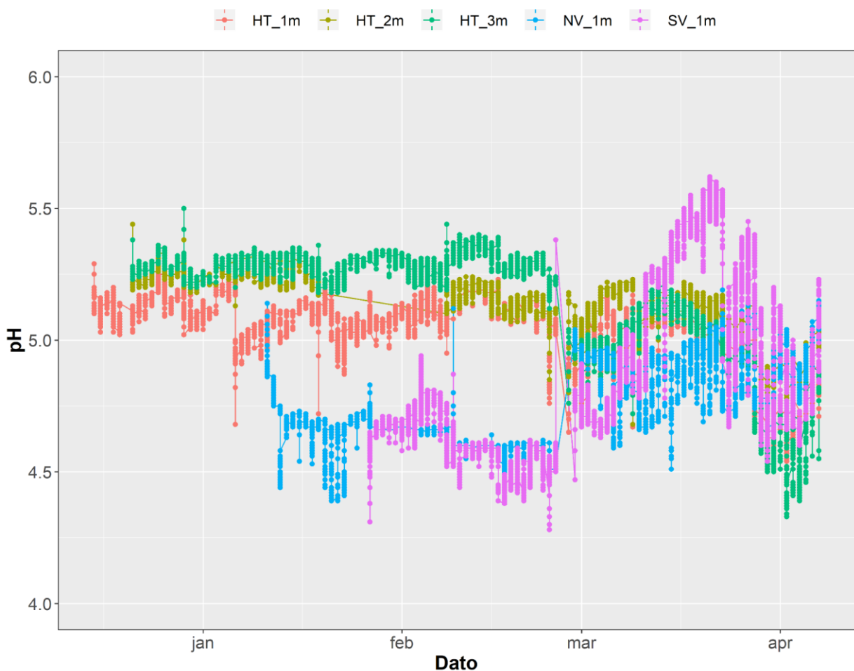
Figur 27: pH-målinger fra loggere i perioden desember 2020, til april 2021. I Holmetjern er det data fra loggere satt på 1,2 og 3 m dyp. For Væhletjerna er målingene tatt fra loggere på 1 m dybde. Orange linje: pH data fra logger i Holmetjernet på 1 m dyp. Gul linje: pH data fra logger i Holmetjernet på 2 m dyp. Grønn linje: pH data fra logger i Holmetjernet på 3 m dyp.
