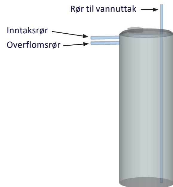
Figur 87. Prinsipp for vanntank og system.
