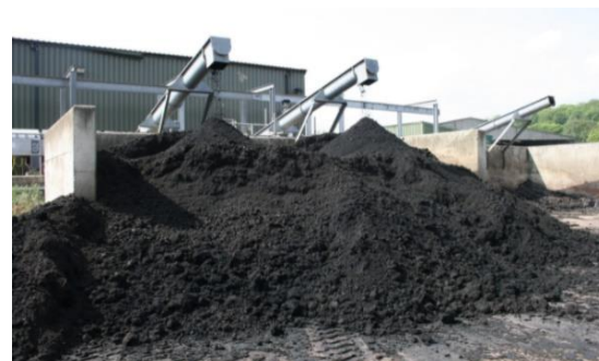
Figur 28: Bildet viser et anlegg med stabilisert slam, og er hentet fra: https://www.ciwem.org/training/sludge-treatment-and-management
