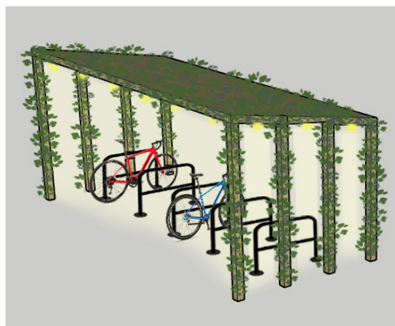
Figur 5.7: Overbygd A-sykelstativ med klatreplanter og belysning.
