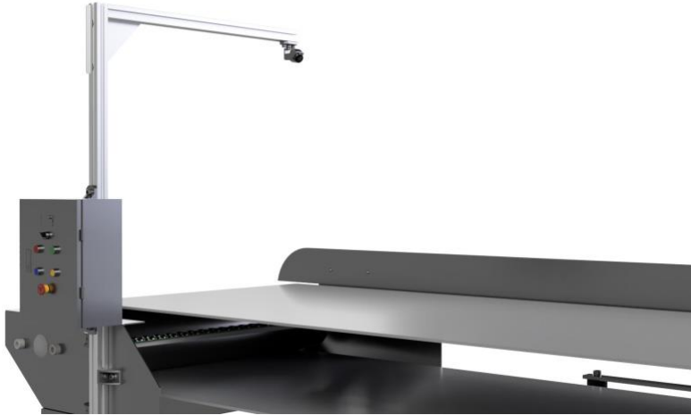
Figur 10: Illustrasjon av sensorsystemets plassering og design ved samlebåndet
