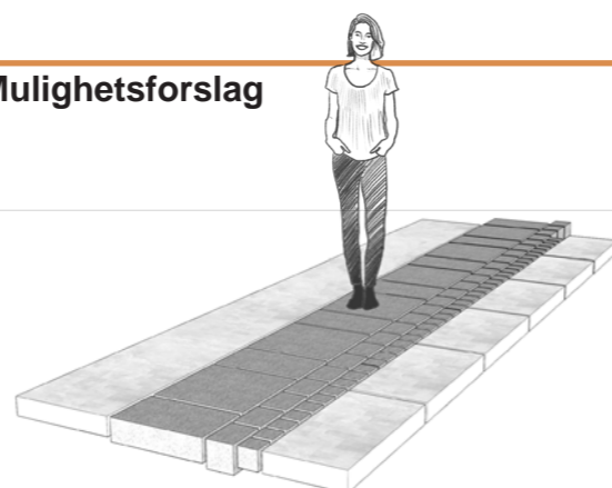
Figur 4.41. Test av hvordan fasadeelementene (ytterst) kan fungere som dekke i kombinasjon med naturstein (i midten).
