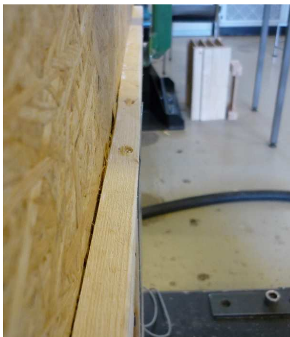
Figur 5.5: Forsterket brudd hos prøve 41a5. Skjærtøyning drar flens ut samtidig som vertikalkrefter trekker den til brudd.
