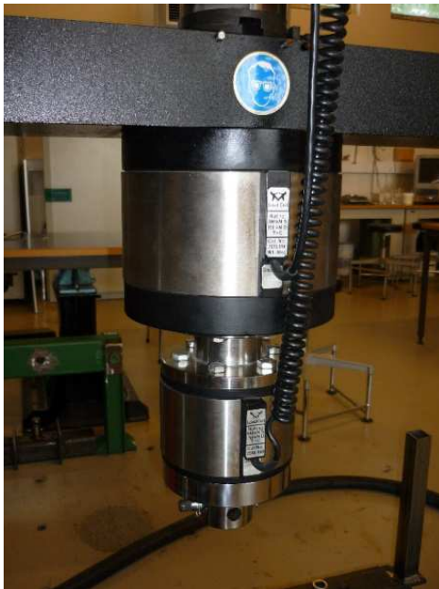
Figur 3.11: Kraftcelle på 100 kN montert under kraftcelle på 300 kN.
