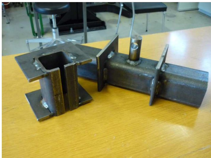
Figur 3.8: Ramme til innfesting av prøveserie 21a og 21c. Den ene 130 mm lang, den andre 400 mm.
