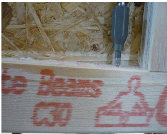
Figur 5.9: Tydelig uttrekk av flens hos prøve 42a3. Uttrekk avtar mye fra kant av lask. Bildet er tatt etter endt forsøk og uttrekk er følgelig større enn ved brudd.
