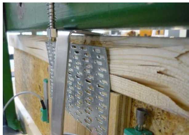
Figur 5.12: Brudd oppstod ved stort tverrstrekkbrudd i øvre flens som førte til forankringsbrudd. Det oppstår glidninger i lask som igjen fører til uttrekk av nedre flens
