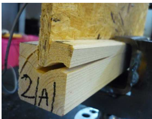
Figur 5.3: Brudd utviklet seg raskt til den ene kant og det oppstod tverrstrekkbrudd i tillegg til uttrekk av flens
