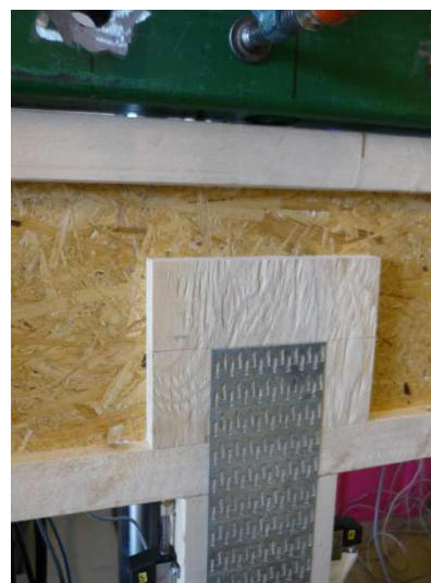
Figur 5.4 Forbindelse er forsterket ved ytterligere forankring i kryssfinerlask hos prøveserie 42a (og 44a).
