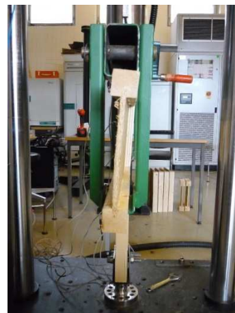
Figur 5.15: Utbredt vipping, særlig for prøvene som endte med tverrstrekkbrudd i øvre flens. Her etter brudd.
