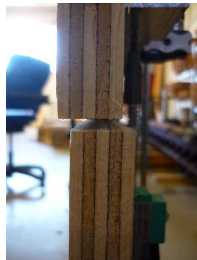
Figur 5.1: Det oppstod skjevheter mellom plater i forbindelse, prøveserie 32a
