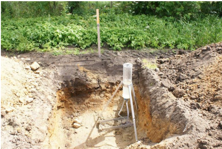
Bilde 4 Infiltrrometer, bilde tatt av Storm Aqua
