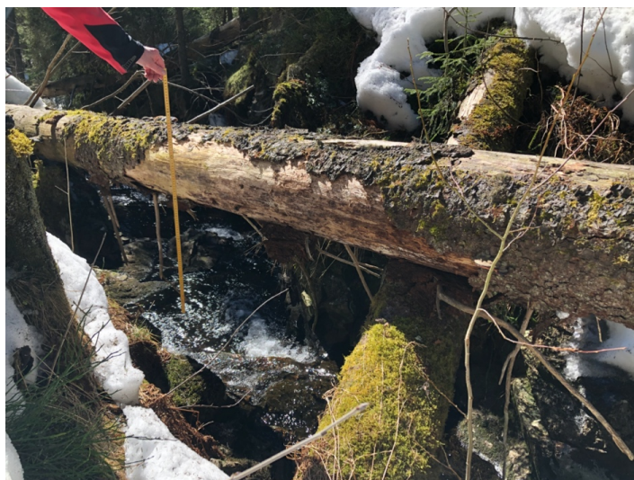
Figur V.23 Her er høyden fra normalstrømningen 1.5 meter. Bekken ligger inntil turstien derfor anbefales det ikke å bygge en demning høyere enn 1 meter. Det er stein og fjell på begge sider, derfor ingen fare for erosjon.
