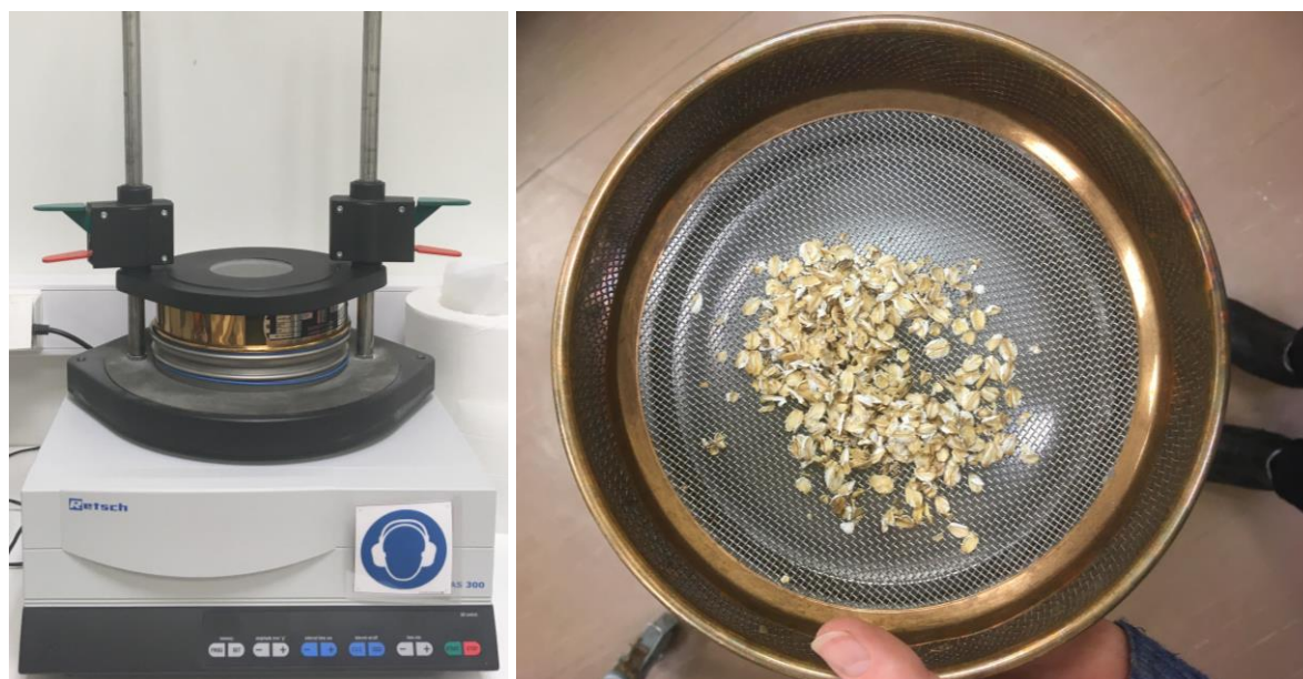
Figur 3.7a-b. a) Siktrister (Retsch Sieve Shaker AS 300, Retsch, England) og b) sikt (Endecotts Ltd., London, England) med masker på 1,4 mm. Bildene er tatt under testforsøk.
