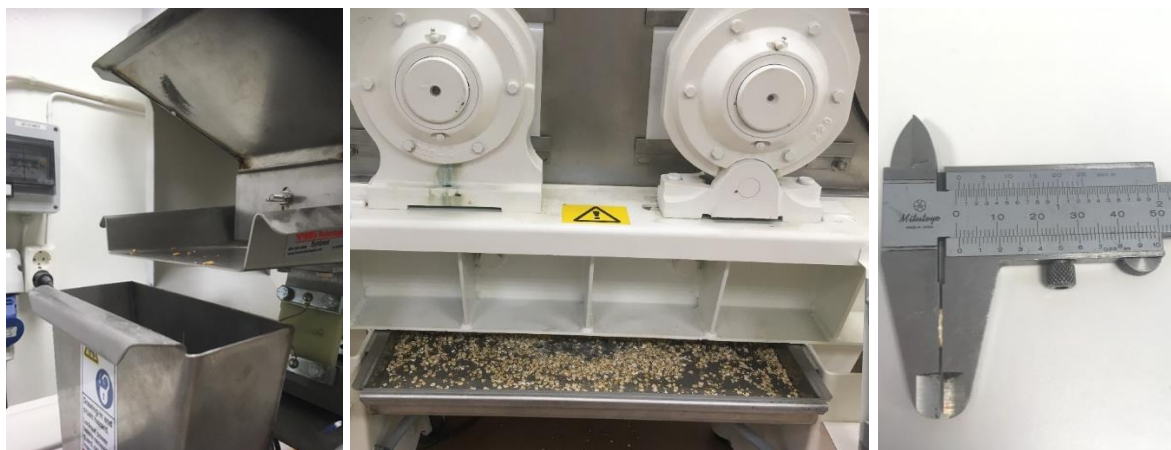
Figur 3.5a-c. a) Trakt med vibrerende Brett, b) flakemaskin med skuff til havregryn under valser, og c) skyvelære for måling av flaktykkelse (Mitutoyo, Japan)).
