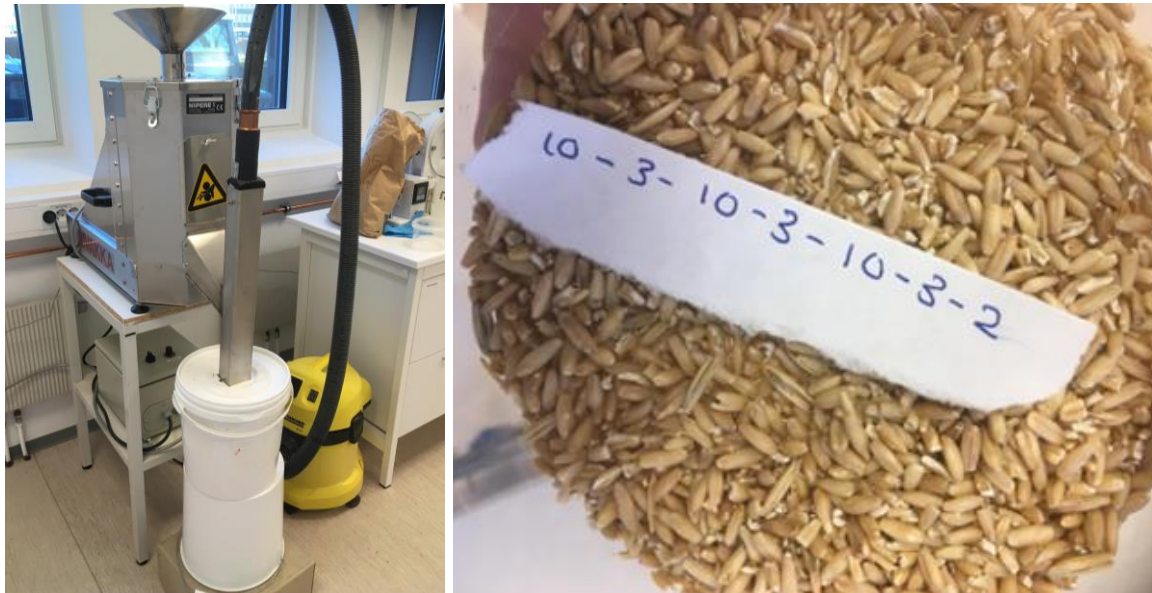
Figur 3.3a-b. a) Havreavskaller (Rivakka, Nipere Ltd., Finland) med tilkoblet grovstøvsuger (Kärcher MV 3 P, Kärcher AS, Norge) og b) avskallede korn fra testforsøk.
