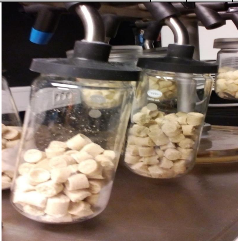
Figur 2.2. Frysetørkemaskin. Glasskolbene med pellet ble festet til maskinen og frysetørket ved hjelp av nedkjølt luft ( -40^{\circ}\text{C} ) tilført via ståltuten i lokket.
