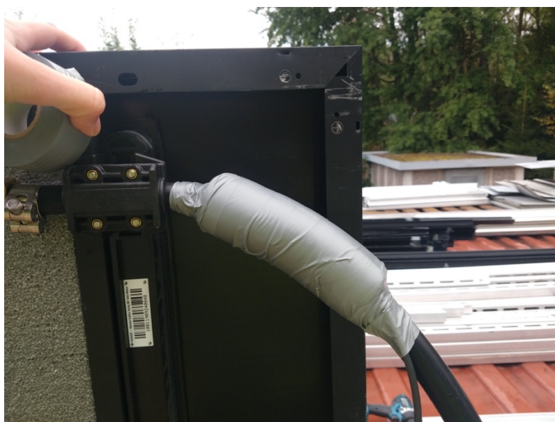
Figur 25: Bilde av hvordan temperatursensorene ble isolert for å måle inn- og utløpstemperatur til PVT panelet i forsøket tilkoblet en termisk krets.
