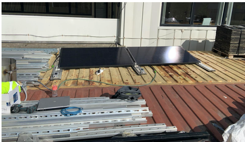
Figur 24: Oppsett av forsøk i Fredrikstad med to Spring 315M moduler. Modulen til venstre er tilkoblet en termisk krets mens modulen til høyre skal brukes som referanse PV-panel.
