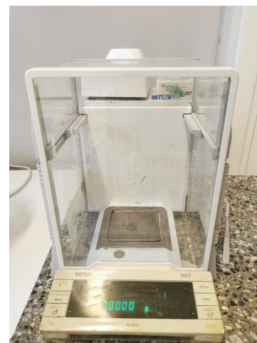
(c) Vekt av typen METTLER AT200
