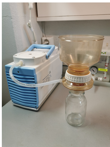
(a) Vakuumsystem med pumpe av typen Diaphragm Vacuum Pump
