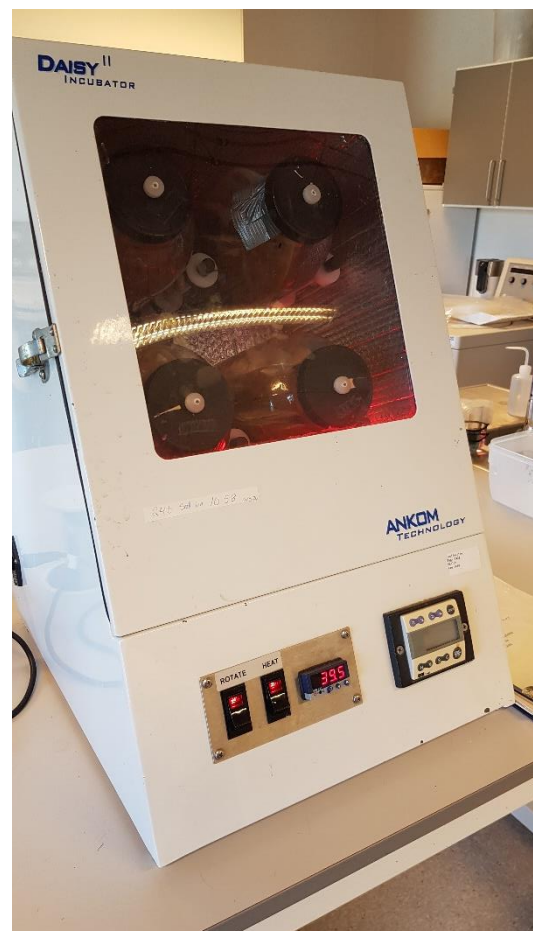
Figur 4. Bilde av benyttet Daisy II inkubator. Gjennom glasset på døra og inn til inkubasjonskammeret vises de fire inkubasjonsglassene. Foto Ole Berner Bondø
