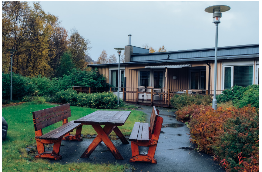
Fig 49: Mastbelysning langs gangvegen skaper oversikt. Mastene er omtrent på høyde med himlingen på byggets første etasje.
