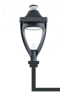
Legend MSU LED Farge: Pulverlakkert grå 9000, teksturert finish Lumen: 6522 Fargetemperatur: 3000K Mnteringshøyde: 4m Montering: Monteres på vegg med gjenget rør til sokkel
