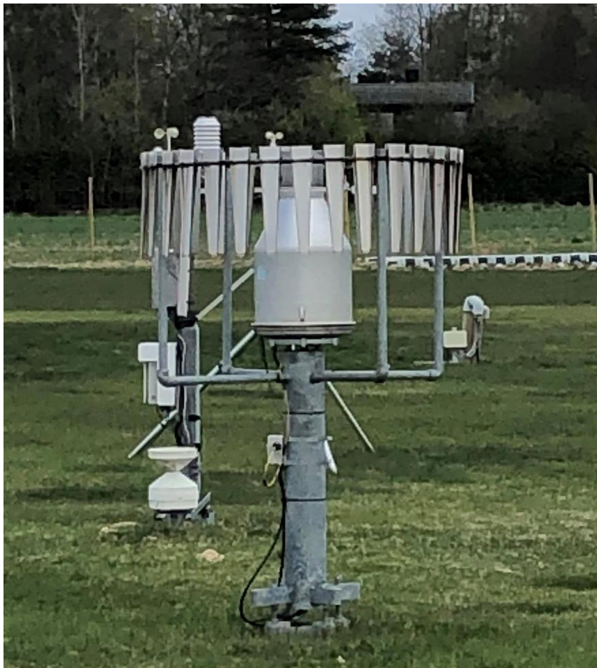
Figur 3: Bildet viser en Geonor nedbørmåler med Alter-skjerming plassert på NMBU sitt testområde på Søråsjordet, Ås.
