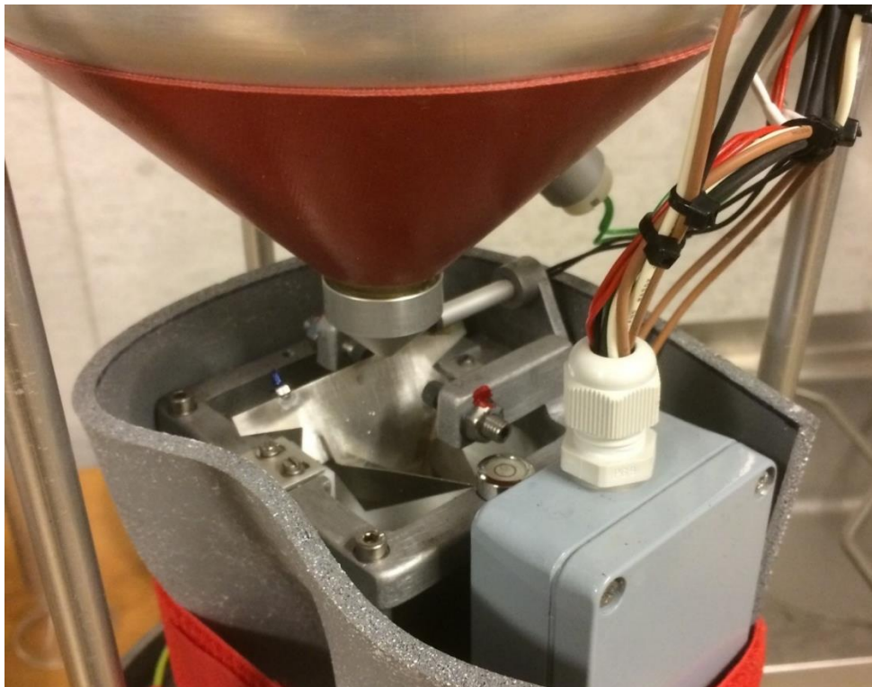
Figur 1: Figuren viser et vippepluviometer. Når instrumentet er installert, er det plassert i en beskyttende beholder som skjermer mot ytre påvirkninger.
