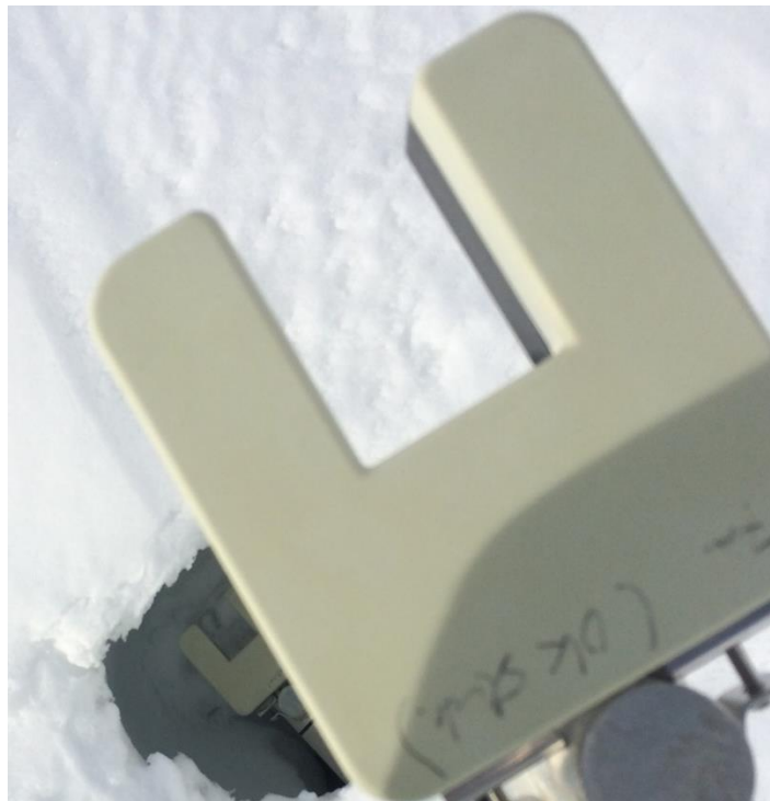
Figur 4: Bildet viser en Thies Clima benyttet som Ja/Nei- sensor på stasjonen Haukeliseter Testfelt (stasjonsnummer 33950).
