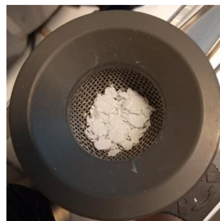
Figur 44. Grovfilter med PU mikropartikler syntetisert med mikrobølger, AL-21
