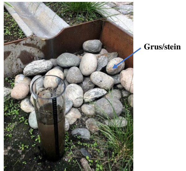
Bilde 5: Måling ved innløp med grus/stein.
