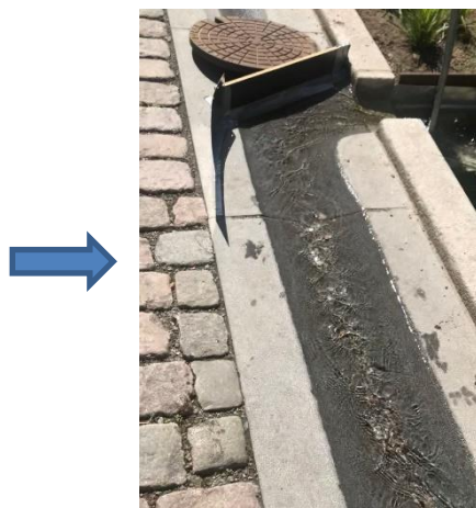
Bilde 2.7: Det ble benyttet en hindring for å lede alt vannet inn i regnbedet.
