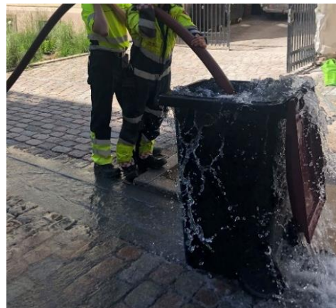
Bilde 2.4: Viser «vann-i-bøtte»-testen med en tom søplebøtte. Volumet til bøtten stod under bøtten.
