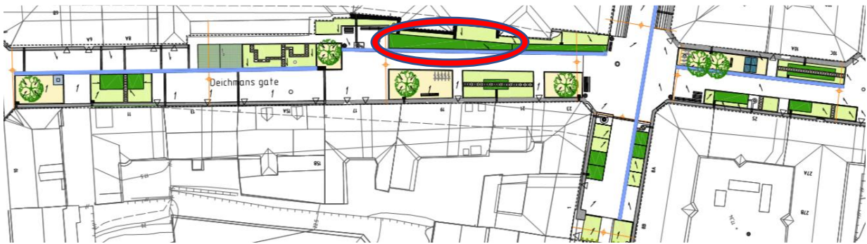
Figur 1: Landskapsplan av Deichmans gate/Wilses gate (Oslo kommune Bymiljøetaten, 2015). Rød sirkel viser hvor regnbed 2 er lokalisert i gata.
