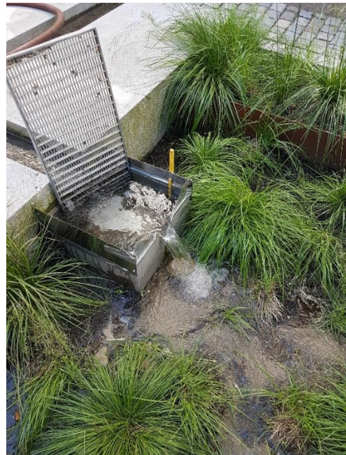
Bilde 2.10: Vannet rant inn i regnbed 7, og målingene ble notert.
