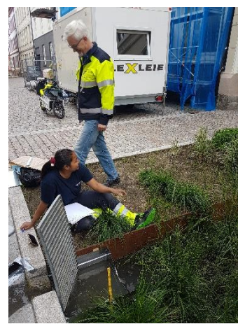
Bilde 2.6: Vannet rant inn i regnbed 1 og målingene ble notert.
