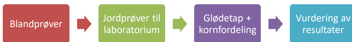
Figur 2.16: Viser fremgangsmåten for bestemmelse av jordart i regnbedene.
