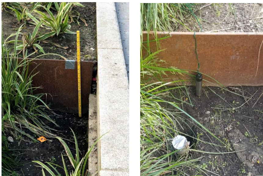
Bilde 2.12: Tommestokk og logger til måling av vannstand i regnbedene.
