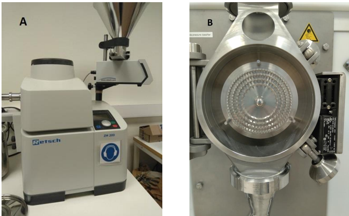
Figur 4 Til venstre er et bilde av en hammermølle av type Retsch (A). Til høyre er et bilde av en pin-mølle (B). Bildet viser disken som roterer i maskinene, den andre disken som er i døren er ikke vist. Begge bildene er tatt ved Nofima, Ås. Fotograf: Ingeborg Lea Ertesvåg
