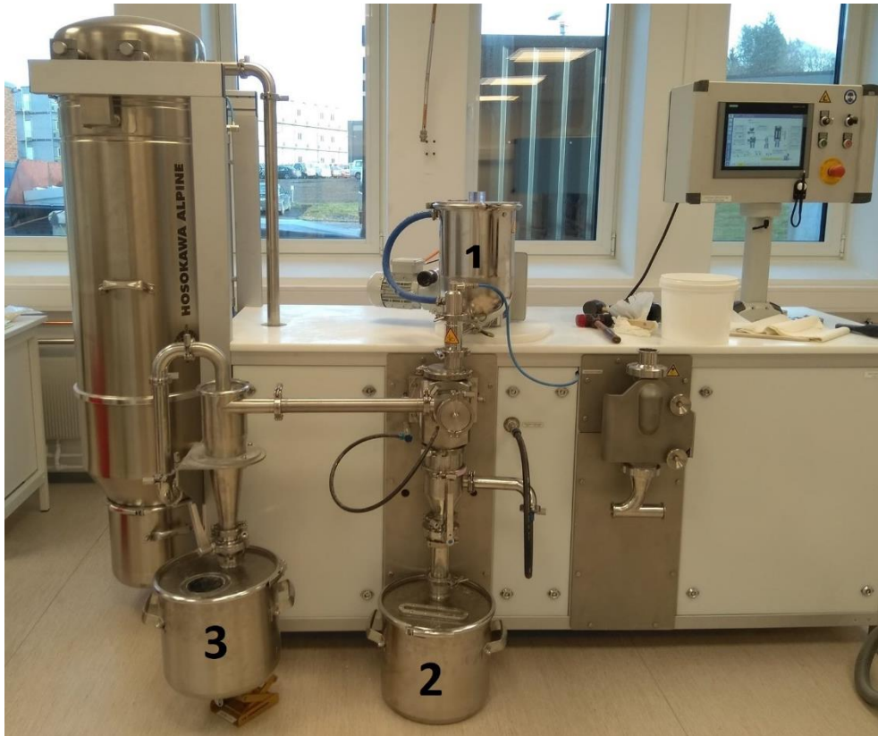
Figur 5 Tørrfraksjoneringsmaskinen benyttet i dette forsøket. Tallet 1 viser hvor råmateriale blir tilsatt i starten av prosessen (materen). Tallet 2 viser hvor GF blir samlet opp. Tallet 3 viser hvor FF blir samlet opp. Bildet er tatt på Nofima, Ås. Fotograf: Ingeborg Lea Ertesvåg.
