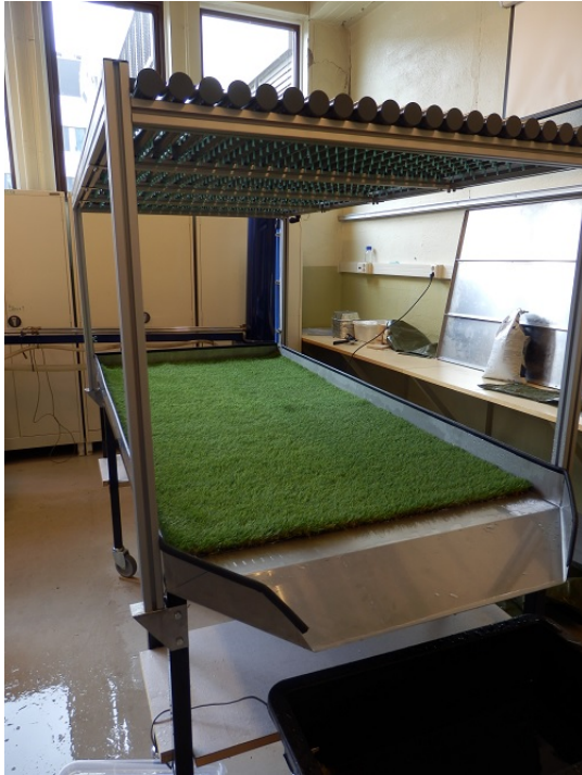
(a) Gressoverflate som nedbørfelt.
