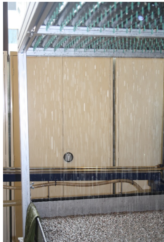
(b) Nedbør på grusoverflaten.
