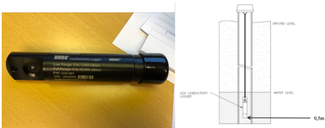
Figur 10: Bilde fremstiller HOBOT U24-001 Fresh Water Conductivity Data Logger og dens plassering i henholdt til vannstand i innløpskummen og utløpskummen til Fossbekken rensedam. Illustrasjon av loggeren i kummen er hentet fra (Corporation, 2011).
