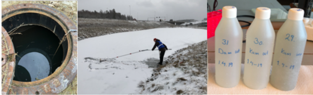
Figur 8: Bilde av vannprøvetaking i innløpskummen og innløpet til rensedammen.
