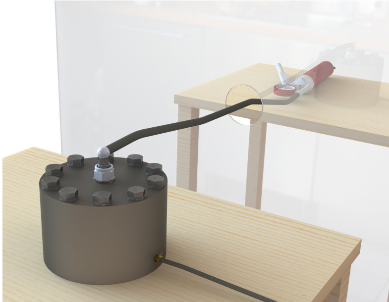
Figur 15.4: Nærbilde av forsøksmodellen som har fettpressen tilkoblet og som er klar for testing. [18]
