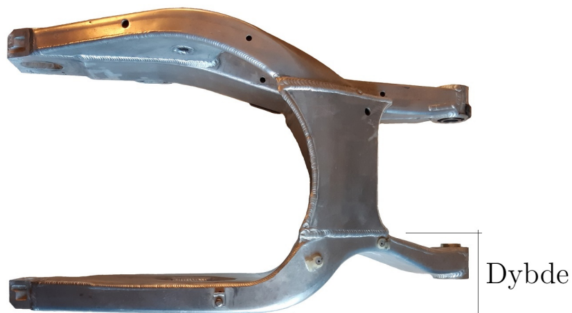
Figur 6.3: Svingarm til Honda VTR 1000 SP2 sett ovenfra. Dybden som vises på bildet er minimumsdybde til den utskiftbare matrisen.
