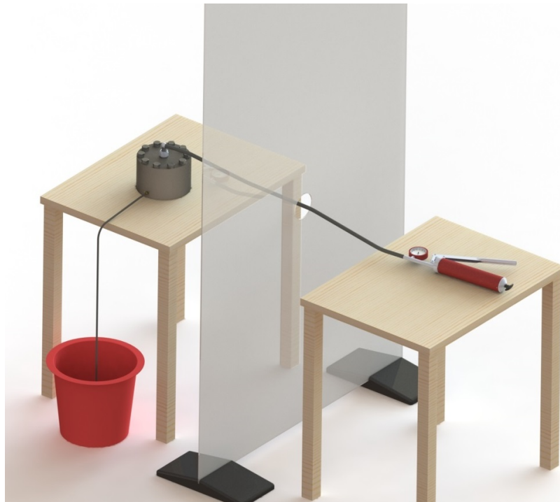
Figur 15.3: Forsøksmodellen er montert og klar for testing. Mellom forsøksmodellen og brukeren er det en sikkerhetsskjerm som sikrer mot eventuelle lekkasjer og andre uforutsette hendelser. I fettpressen som ligger på bordet til høyre er det montert et manometer for å kunne overvåke trykket. Fra trykkammeret er det montert en dreneringsslange som drenerer eventuelle lekkasjer ned i en beholder for å unngå unødvendig søl. [18]
