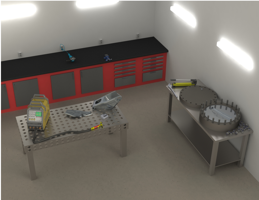
Figur 15.5: På bordet til høyre står en prototype med innvendig diameter på 600mm. På sveisebordet midt i bildet ligger en metallplate som er formet og klar til å sveises til en svingarm. [18]
