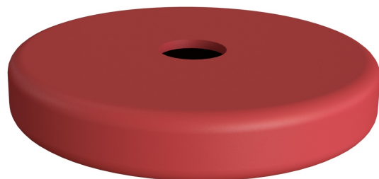
(b) Membranen som holder på fettene og former metallplaten mot matrisen.
