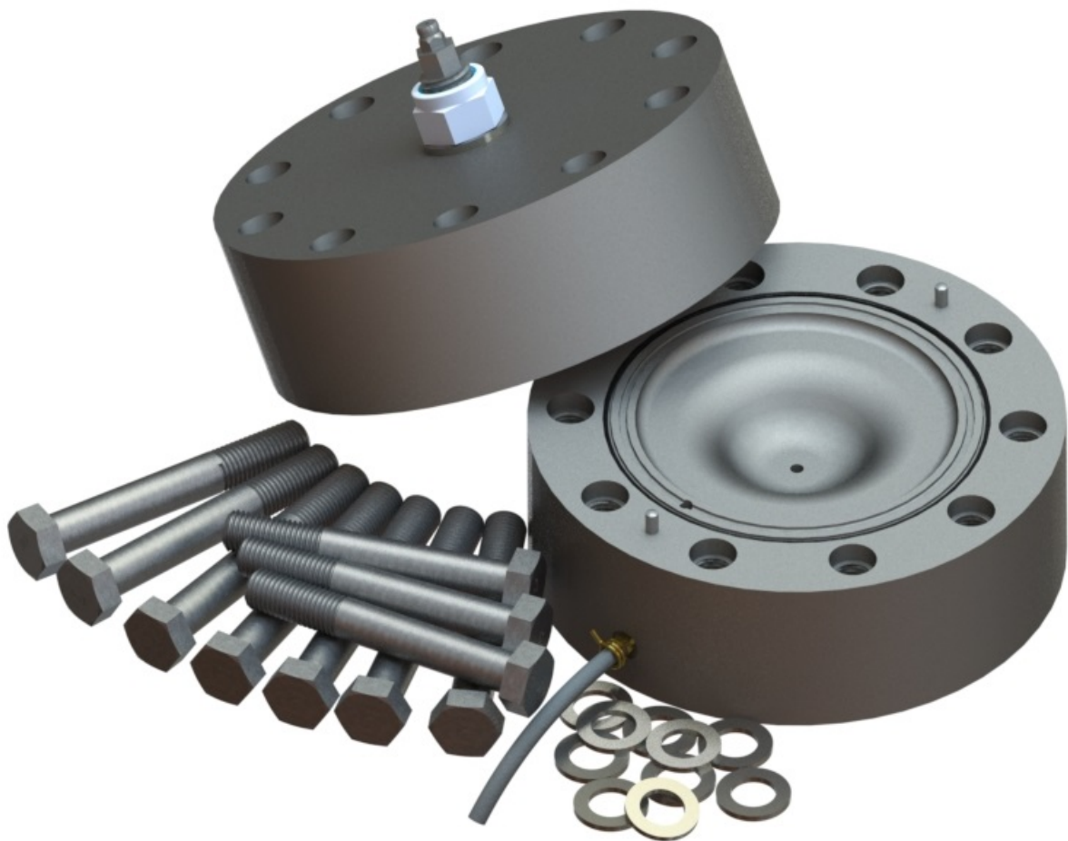
Figur 15.1: Forsøksmodellen er klar for testing. Trykkammeret er komplett med dreneringslange som drenerer eventuelle lekkasjer. I lokket er membranen integrert og på nippelen på toppen festes fettpressen som skal lage trykket. Skruene og skivene som brukes for å koble sammen lokk og trykkammer ligger i forgrunnen.
