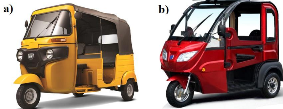
Figur 1.8.: Et populært framkomstmiddel: a) Nyere utgave av den tradisjonelle Indiske TukTuk-en. b) Kinesisk El-Rickshaw (Chongqing) med 800 Watt elektrisk motor og 80 Ah batteri (16,17).
