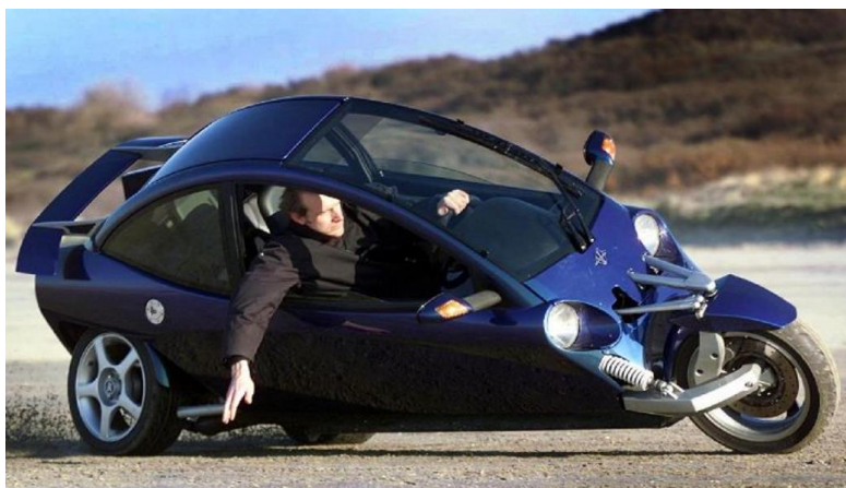
Figur 1.9: Tidlig Vandenbrink Carver trehjuling, med bakmontert motor og drivverk, og en fremre del med førerplass og nese-hjul som kan tilte sideveis med styreutslaget (19).
