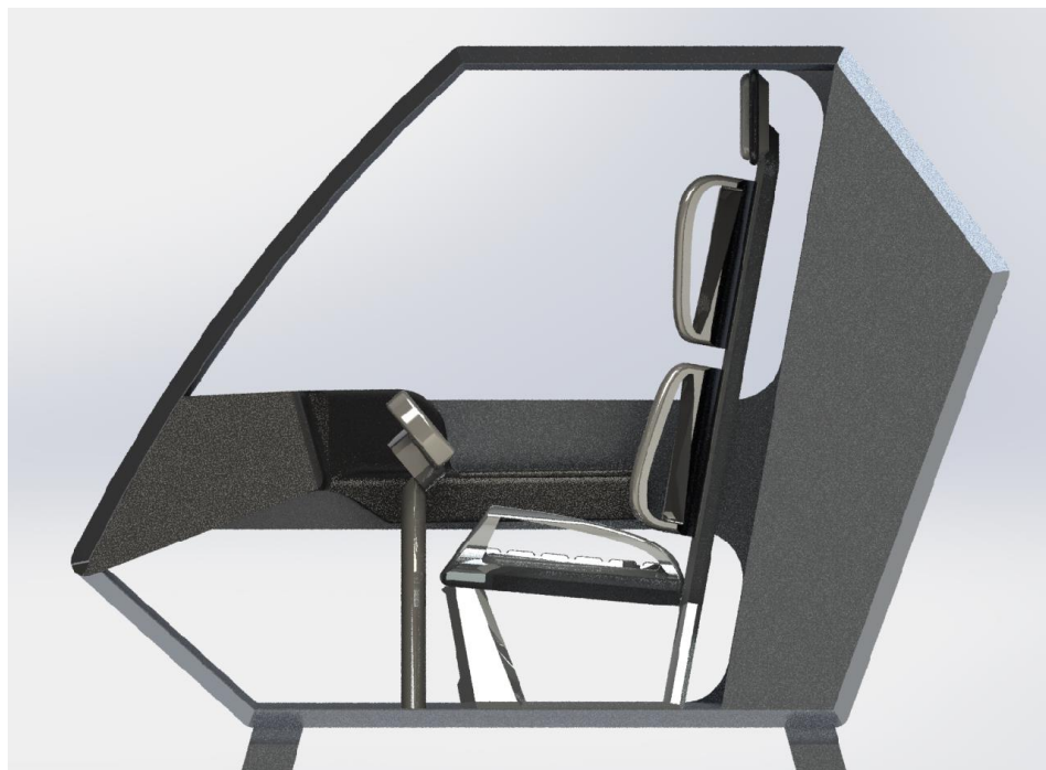
Figur 12.4: Innstigning til førerkupeen med åpen dør. Sidebuene på setet gjør det lettere å komme inn siden du kan gripe tak i kanten.
