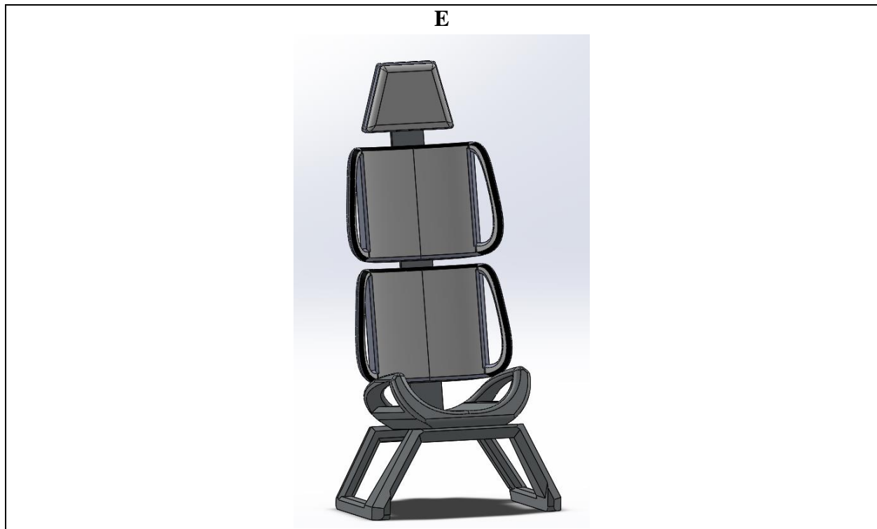
Figur 8.14: A-E) Samling av 3D-illustrasjoner for siste versjon i utviklingstrinnene fra utkast til setet med rett rygg 5 grader setevinkel og nytt understell.
