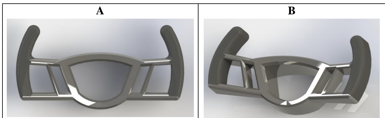
Figur 8.17:A-B) Ferdig design på ratt med aluminium og kunstlær på håndtakene. I senter vil det kunne bli plassert en logo eller annet instrumentering.
