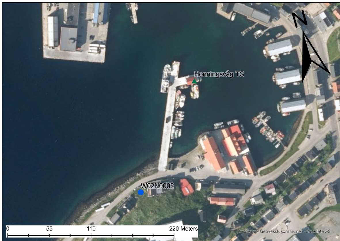
Figur 3.10: Illustrasjonskart over sikringspunkt og vannstandsmåler i Honningsvåg.
