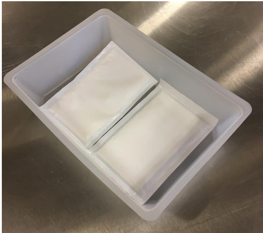
Figur 3: To CO 2 emittere plassert i emballaseløsningen HDPE light som skal pakkes med 100 % CO 2 (foto: privat).
