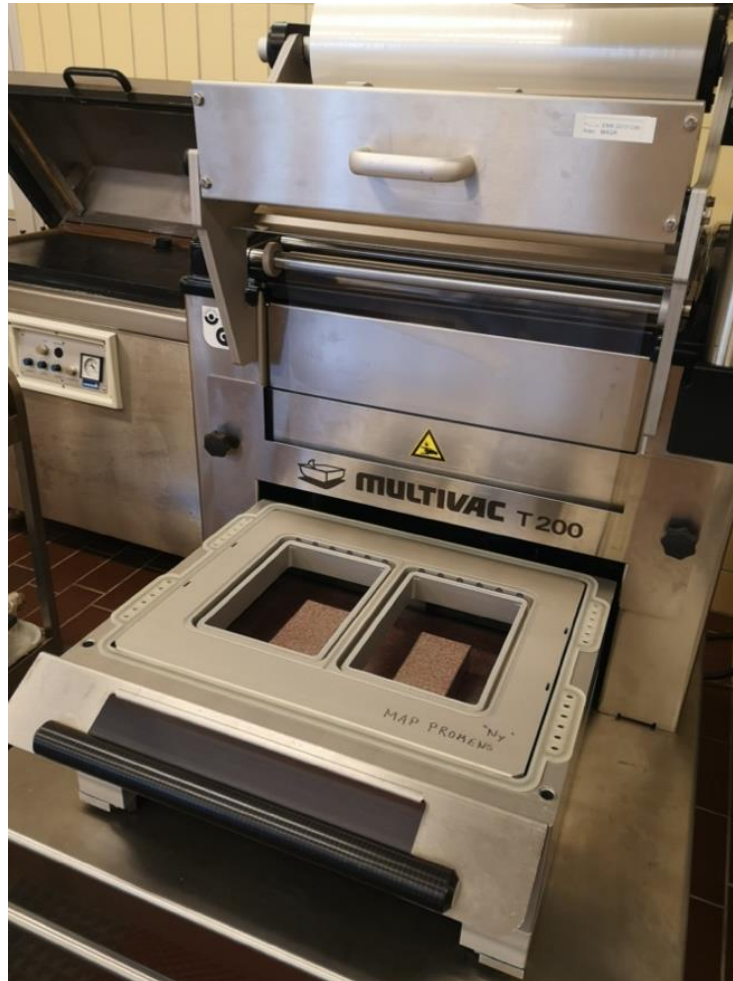
Figur 2: Skålpakkemaskinen Multivac T200 (Multivac, Wolfertschwenden, Germany) i pakkehallen på Nofima (foto: internt, Nofima).
