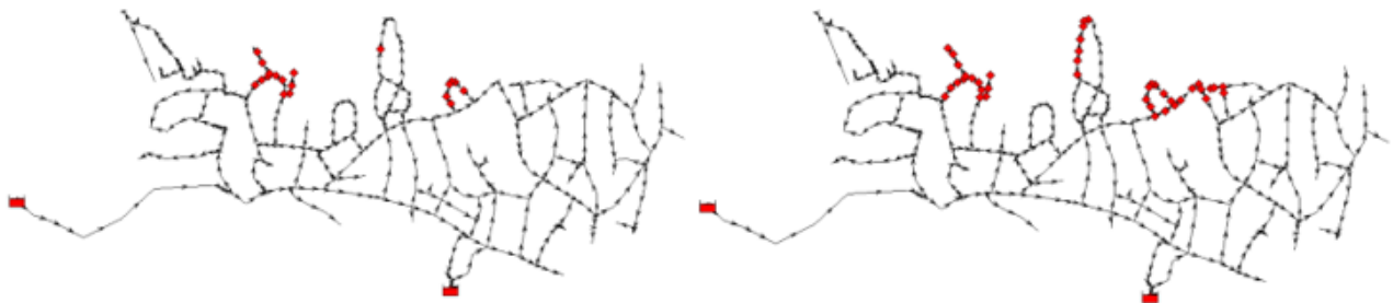
Figur 50: Noder (markert rødt) med resttrykk mellom 10-20 mVS ved nattestid (t.v) og ettermiddag (t.h) for Bermad
