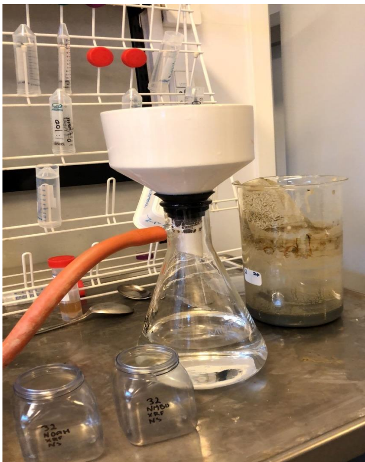
Figur 11: Oppsettet brukt til filtrering. Viser erlenmeyerkolbe, buchner trakt øverst, og pumpen koblet til.
