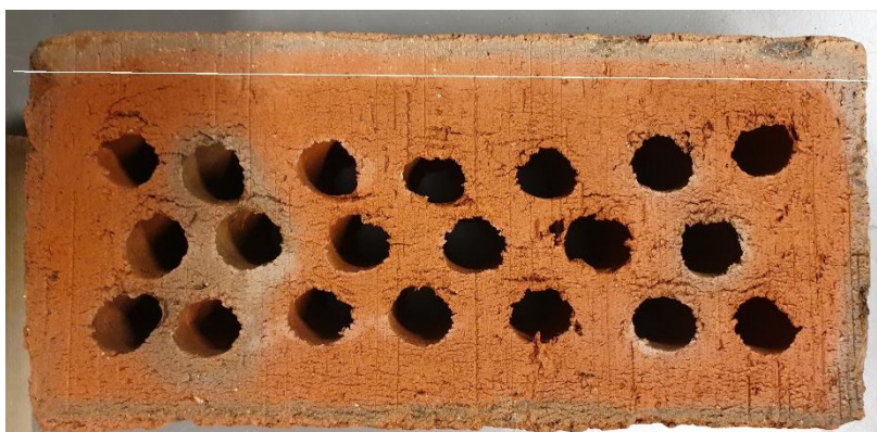
Figur 4.6: ALNA-tegl etter 10 minutters oppvarming med varmerigg, den hvite linjene viser skillet mellom synlig tørr og synlig våt tegl.
