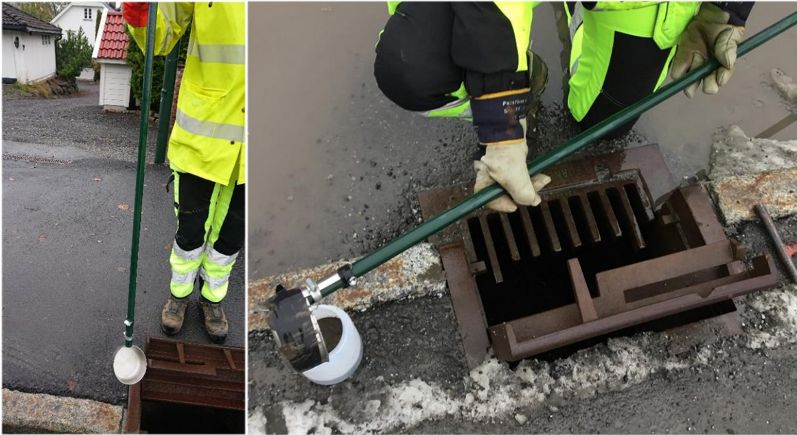
Figur 27 Prøvestang m/ øse til sandfangsmassene
