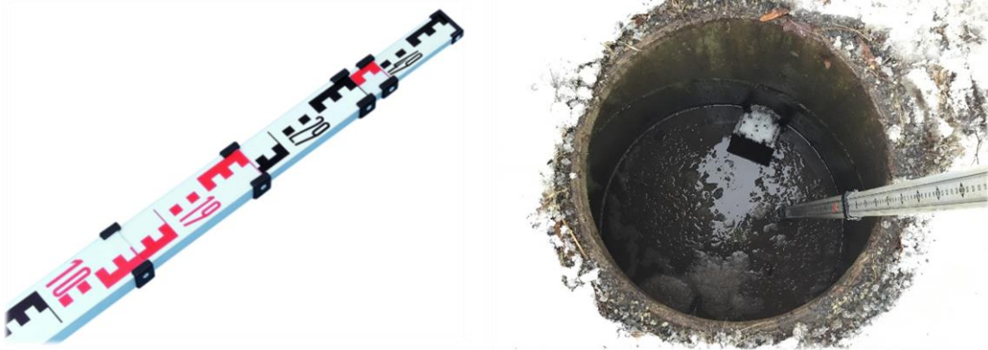
Figur 28 Fra venstre: nærbilde av målestav (Bilde er hentet fra Wurth's produktblad), nedmål med målestav
