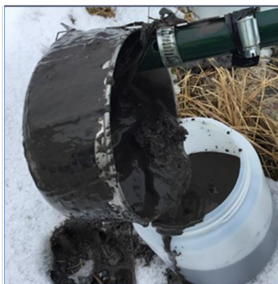
Sandfangsmasser med høyt innhold av finstoff Fra: Vogellund
