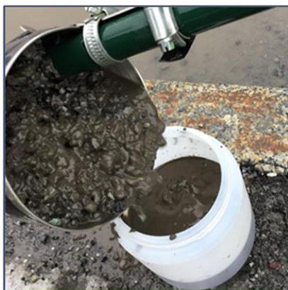
Sandfangsmasser med høy andel grus- og strøsand Fra: Otto Blehrs vei
