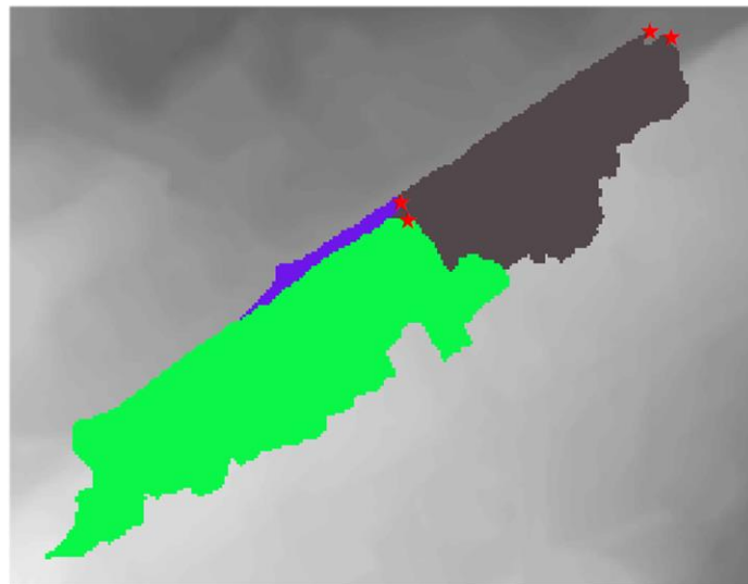
Figur 19 Eksempel på generert nedbørsfelt i ArcMap med røde stjerner som feltutløp/sluk
