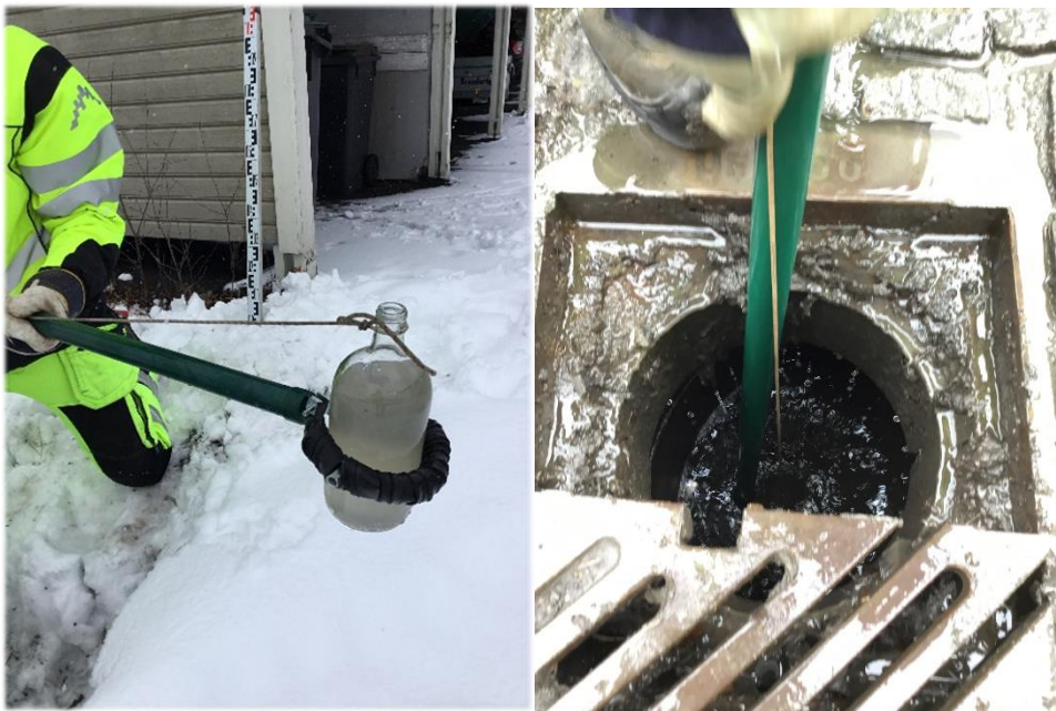
Figur 25 Prøvestang m/ flaske til vannprøver
