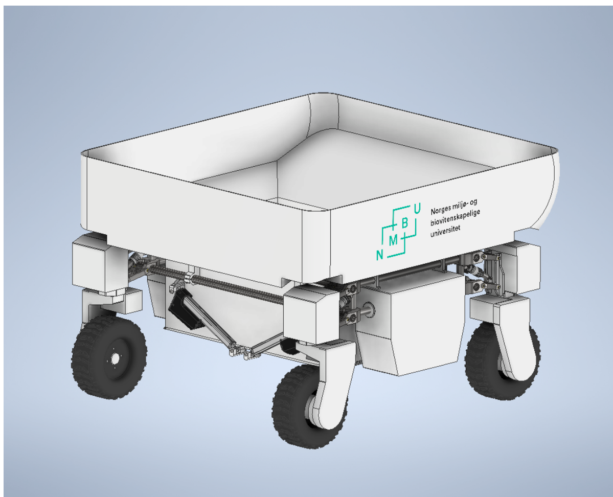
Figur 11.2: Beholderen montert på Thorvald med lukket luke.
