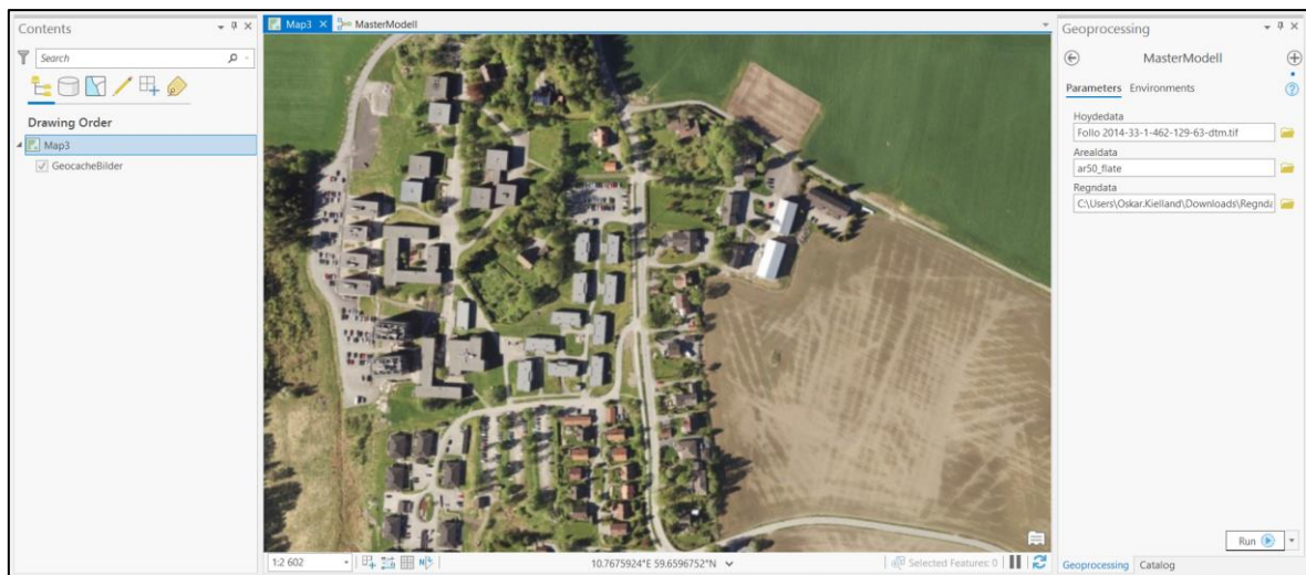
Figur 5-2: Utsnitt av brukergrensesnittet i ArcGIS Pro. ArcGIS-modellen startes ved å legge inn inngangsdata under «Parameters» til høyre, og deretter klikke "Run".
