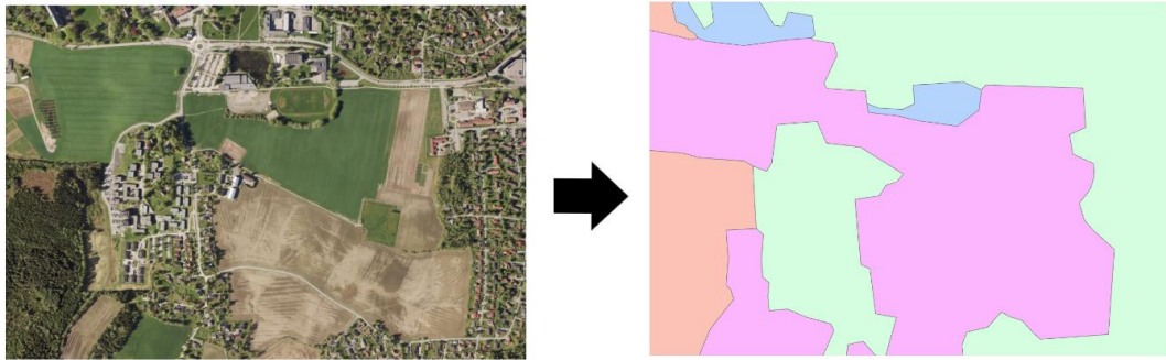
Figur 4-4: Arealtype-inndeling basert på AR50-data i Ås kommune. Inndelingen er relativt grov, spesielt i bebygde områder.
