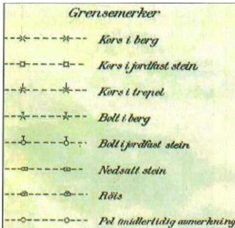
Figur 4: Disse symbolene for grensemerking er de mest brukte – Hentet vestlandsk landbruk nr. 10, 2000 s.8-10
