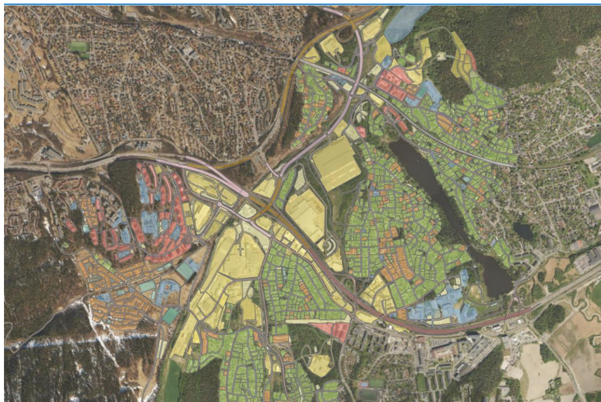
Figur 3.3. Utsnitt fra kartfunksjonen i ArcGIS Pro som viser manuelt inntegnede polygoner som definerer arealbrukslaget brukt i modellen.
