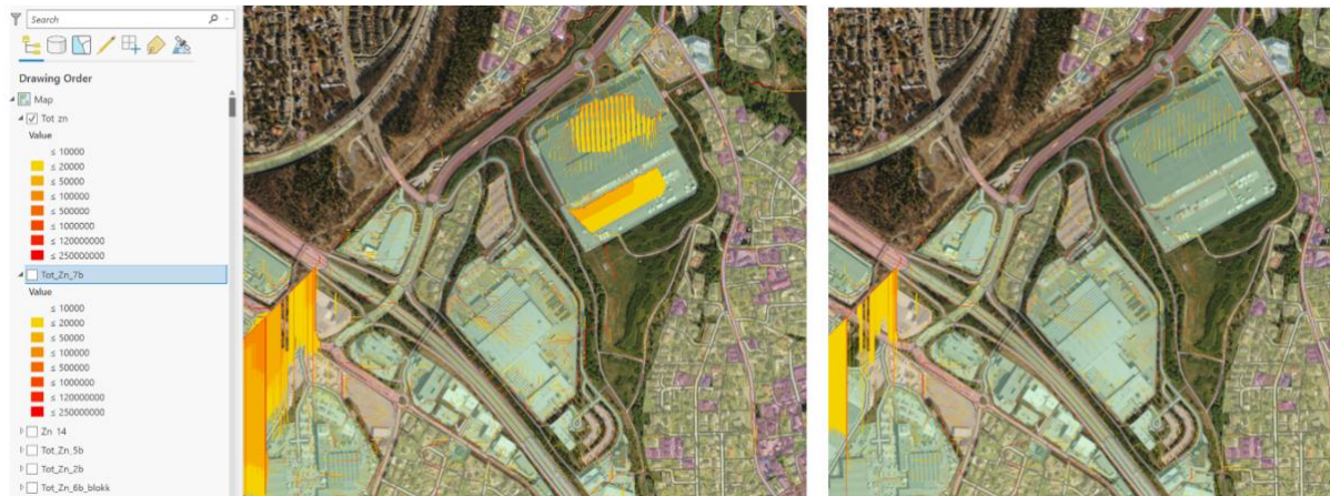
Figur 4.12. Utsnitt fra ArcGIS Pro som viser forurensningsrasteret for sink ved utførte simuleringer med tiltak på industriområder. Til venstre i figuren vises simuleringen som ble utført uten noen fungerende tiltak i nedbørsfeltet. Til høyre i figuren brukes overvannsdam som tiltak på 50% av industriområdene. Symbolforklaringen til venstre viser inndelingen av modellert mengde sink (mg/år) som slippes ut. Mørkere farge indikerer høyere mengde akkumulert sink, i tillegg til at flere rasterceller vises i områder med større forurensningsproduksjon.
