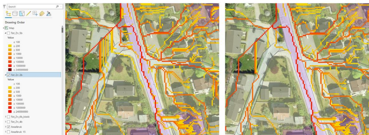
Figur 4.6. Utsnitt fra ArcGIS Pro som viser forurensningsrasteret for sink ved utførte simuleringer med tiltak på kommunale veier. Simuleringen som ble utført med sandfang (middels drift) er vist til venstre i figuren. Til høyre i figuren brukes regnbed som tiltak på 50 % av de kommunale veiene. Symbolforklaringen til venstre viser inndelingen av modellert mengde sink (mg/år) som slippes ut, hvor samme inndeling er brukt for begge simuleringene. Dette medfører at flere rasterceller inkluderes ved høyere forurensningsproduksjon, i tillegg til at fargen på cellene blir mørkere.
