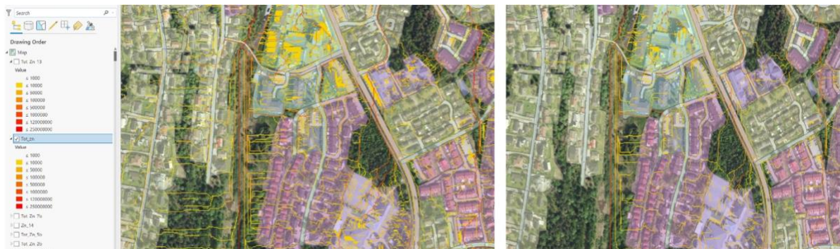
Figur 4.15. Utsnitt fra ArcGIS Pro som viser forurensningsrasteret for sink ved utførte simuleringer med ulike tiltakskombinasjoner plassert i nedbørsfeltet. Til venstre i figuren vises simuleringen som ble utført uten noen fungerende tiltak i nedbørsfeltet. Til høyre i figuren vises simuleringen som ble gjort ved den sammensatte løsningen. Symbolforklaringen til venstre viser inndelingen av modellert mengde sink (mg/år) som slippes ut.
