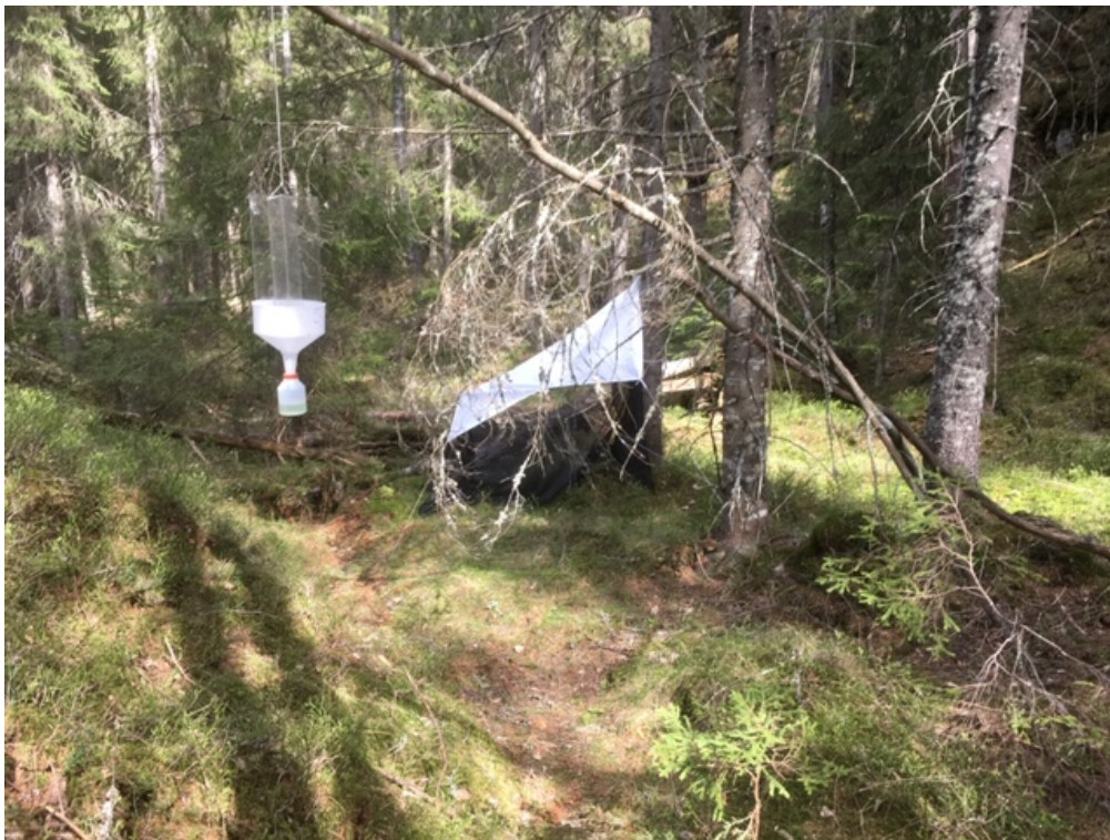
Figur 2: Bilde fra RAM2 i Ramstadslottet naturreservat. En av vindusfellene henger til venstre, og til bak til høyre er malaisefellen. Fotograf: Tone Birkemoe.
