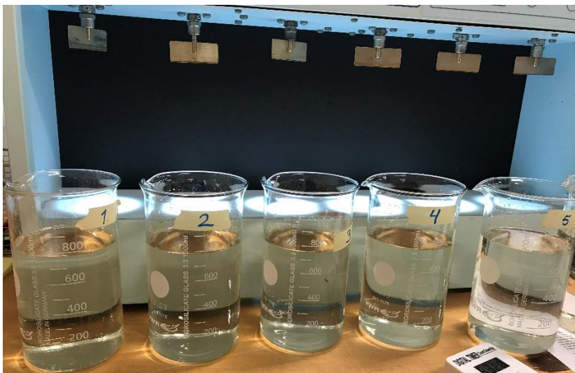
Figur 3-3: Bilde fra Jar-test oppsettet brukt i forsøkene (foto: forfatter).
