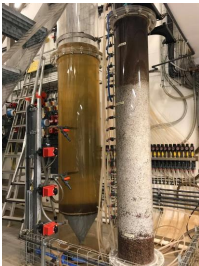
Figur C- 3: Pilotanlegget med trykktransmittere langs filterkolonnen. Sedimenteringskolonnen i bakgrunnen (foto: forfatteren).
